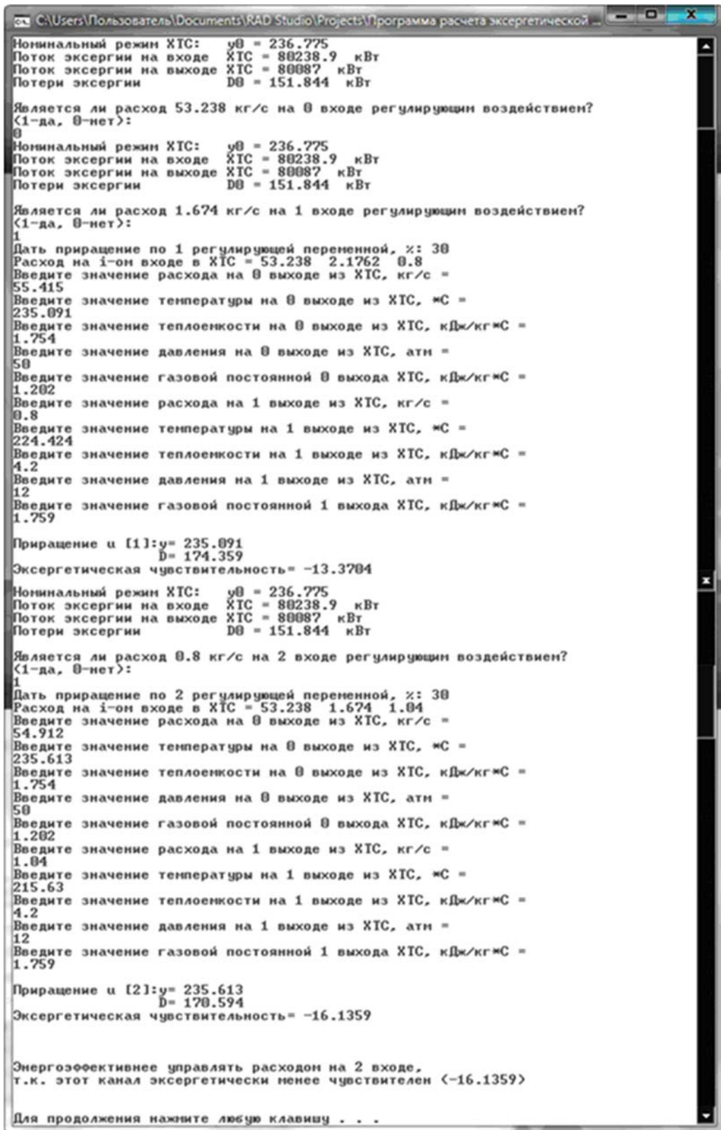
Рисунок 3.27 – Результаты работы программы ExergySensCTS в случае охлаждения газа по высоте колонны
