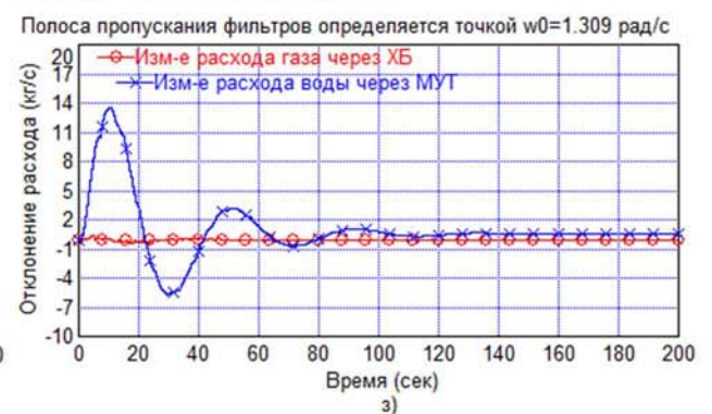
Рисунок 4.30 – Результаты работы моделирующей программы: а), в), д), ж) реакция температуры газа на выходе 2-го слоя катализатора при ступенчатом возмущении по температуре газа после 1-го слоя катализатора \Delta T_1^{(B)} = +3 °C; б), г), е), з) изменение расхода хладагентов в ЭСАР
