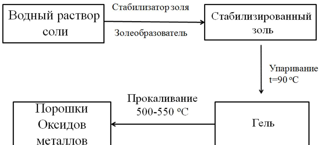
Рис. 38. Схема разработанного золь-гель метода
