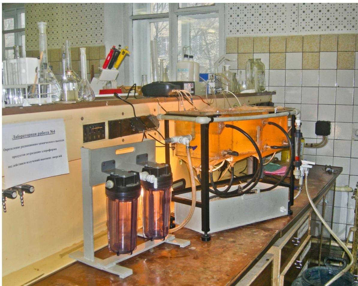
*Рис. 18. Общий вид универсальной лабораторной установки для очистки воды*
