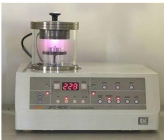
Рис.26 Установка магнетронного напыления JEOL JFC-1600
