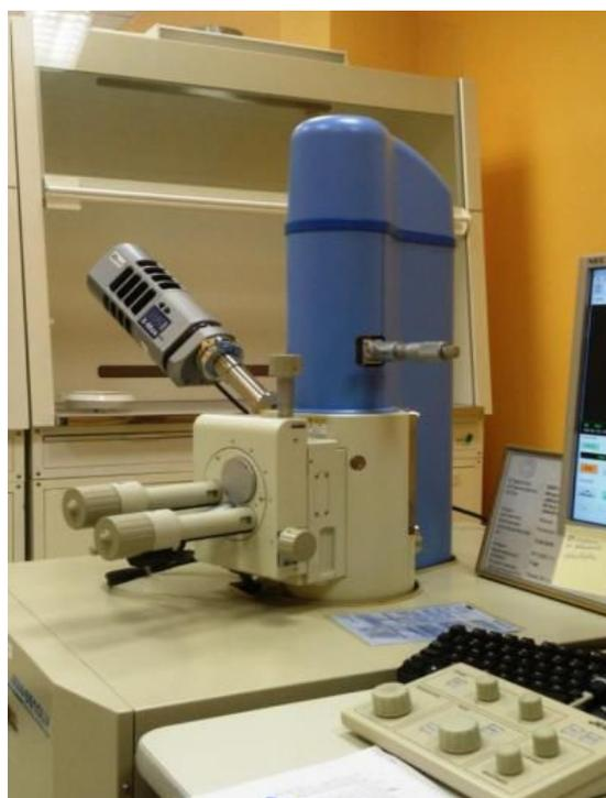
Рис.27 СЭМ JEOL JSM-6510LV
