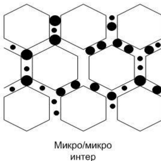
Рис. 3.1. Структура материала типа «микро/микро»
