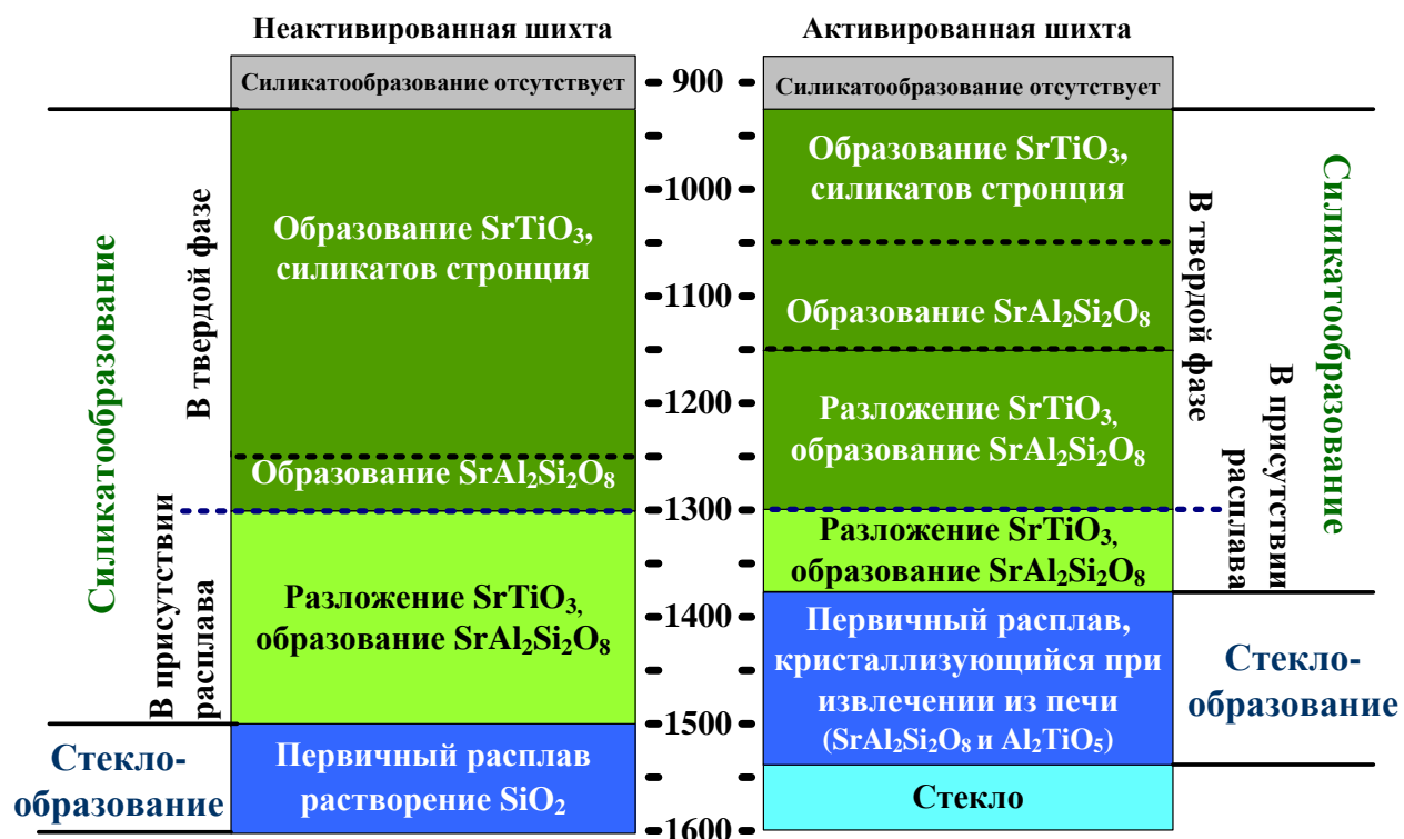
Рис. 54. Схема физико-химических процессов, происходящих в неактивированной и механоактивированной стронцийалюмосиликатной шихте при стекловарении
