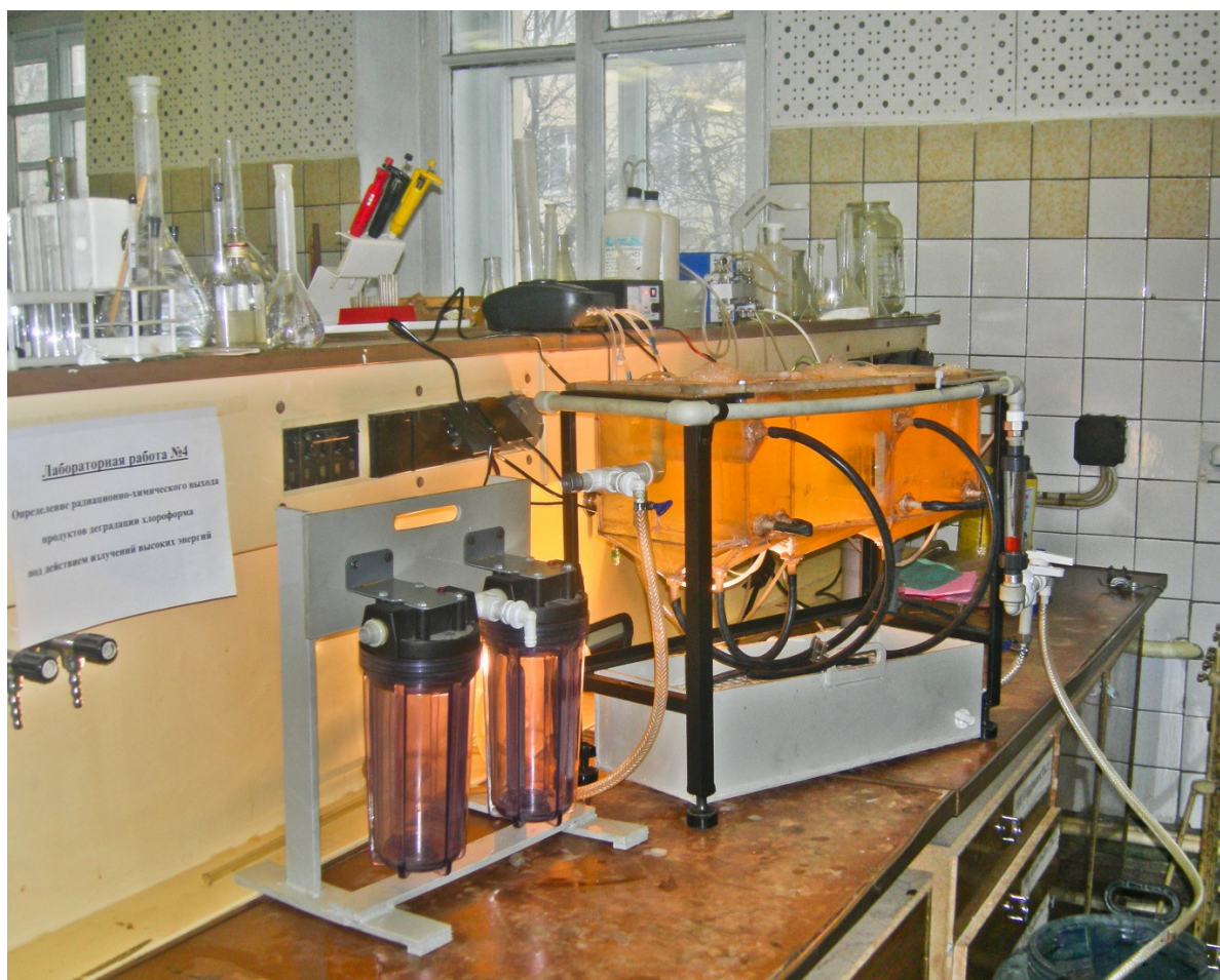
Рис. 18. Общий вид специальной лабораторной установки для очистки воды
