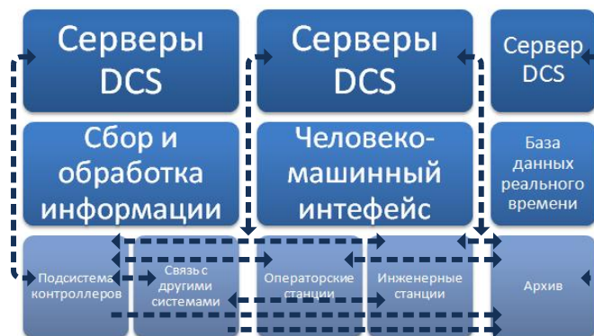
Рисунок 1. Обобщенная структура системы типа DCS
