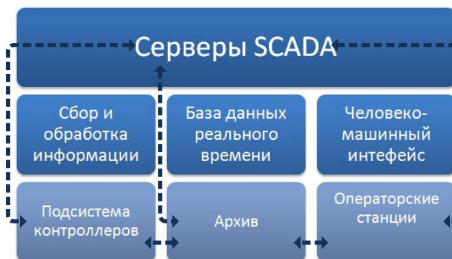
Рисунок 2. Обобщенная структура систем типа SCADA
