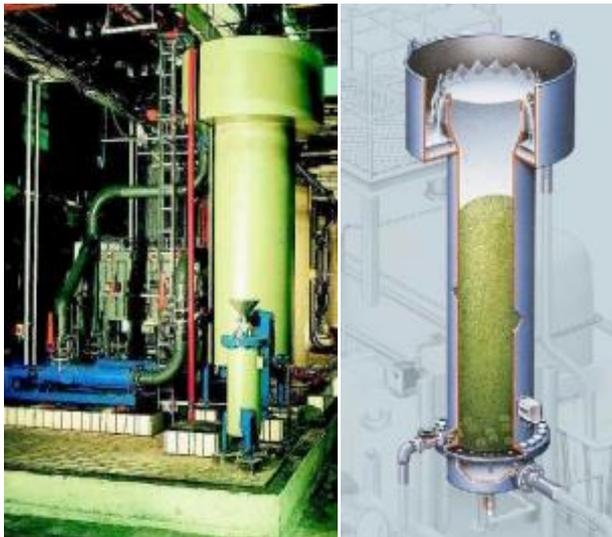
**Рисунок 9. Реактор взвешенного слоя.**
