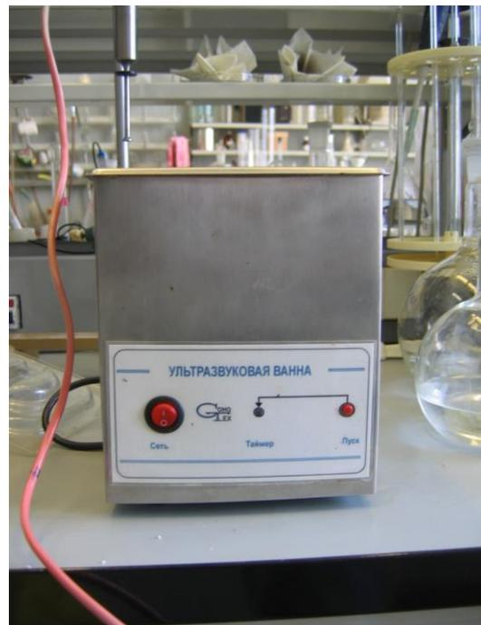
Рисунок 12. Ультразвуковая ванна.
