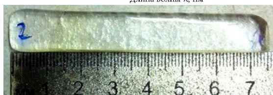
Рисунок 23 – Спектры поглощения участков образца фосфатного стекла а) состава Р60-Аg0,5, термообработанного в градиенте температур 400-570°С в течение 3 ч, и его внешний вид; б) состава Р60-Аu0,01, термообработанного в градиенте температур 320-440°С в течение 3 ч, и его внешний вид
