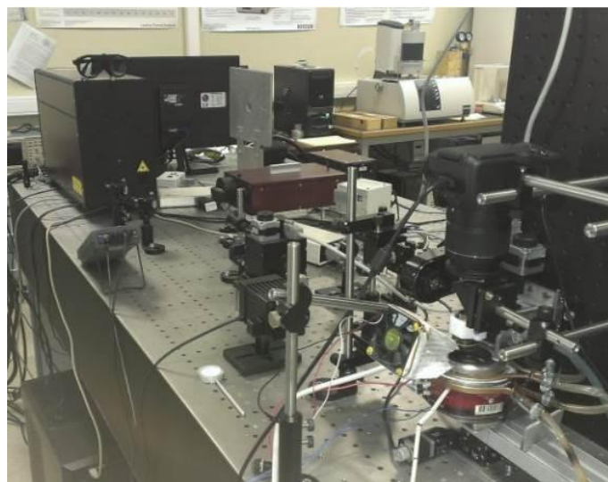
Рисунок 20 – а) Схема экспериментальной установки и б) внешний вид установки для лазерной кристаллизации стекол фемтосекундным лазером
