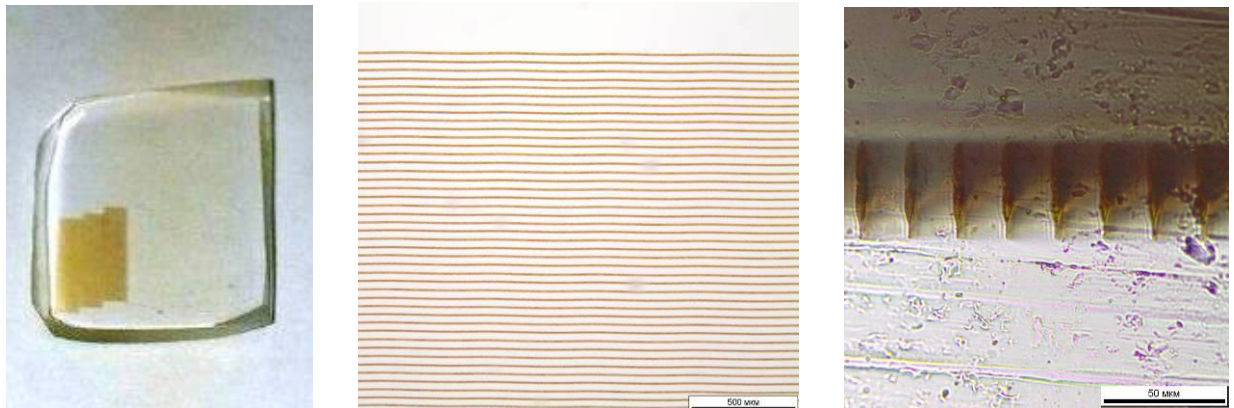
Рисунок 53 - а) Внешний вид образца PZ с облученной зоной и б) продольный, в) поперечный вид сформированной периодической структуры
