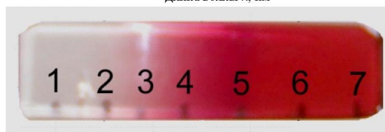
Рисунок 23 – Спектры поглощения участков образца фосфатного стекла а) состава Р60-Аg0,5, термообработанного в градиенте температур 400-570°С в течение 3 ч, и его внешний вид; б) состава Р60-Аu0,01, термообработанного в градиенте температур 320-440°С в течение 3 ч, и его внешний вид
