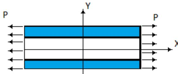
Рисунок 6.3 - Схема нагружения слоистой ячейки периодичности
