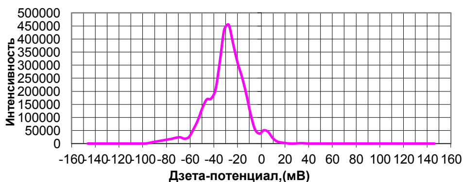
Рис. 3.22 – Результат определения дзета-потенциала поверхности наночастиц кремнезема, образца УФ-17
