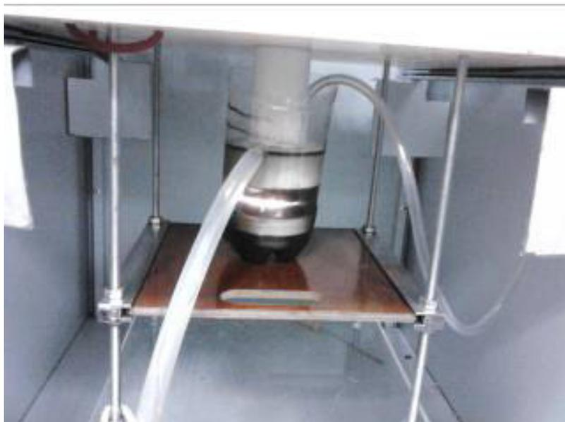
Рисунок 67 – Получение дисперсий оксидов металлов на конденсационно-диспергационной установке
