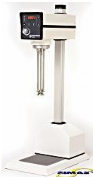
Рисунок 2.4 – Гомогенизатор Silverson L5M
