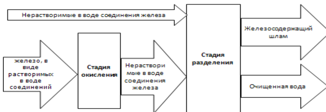
Рисунок 1.1 - Общая схема обезжелезивания.
