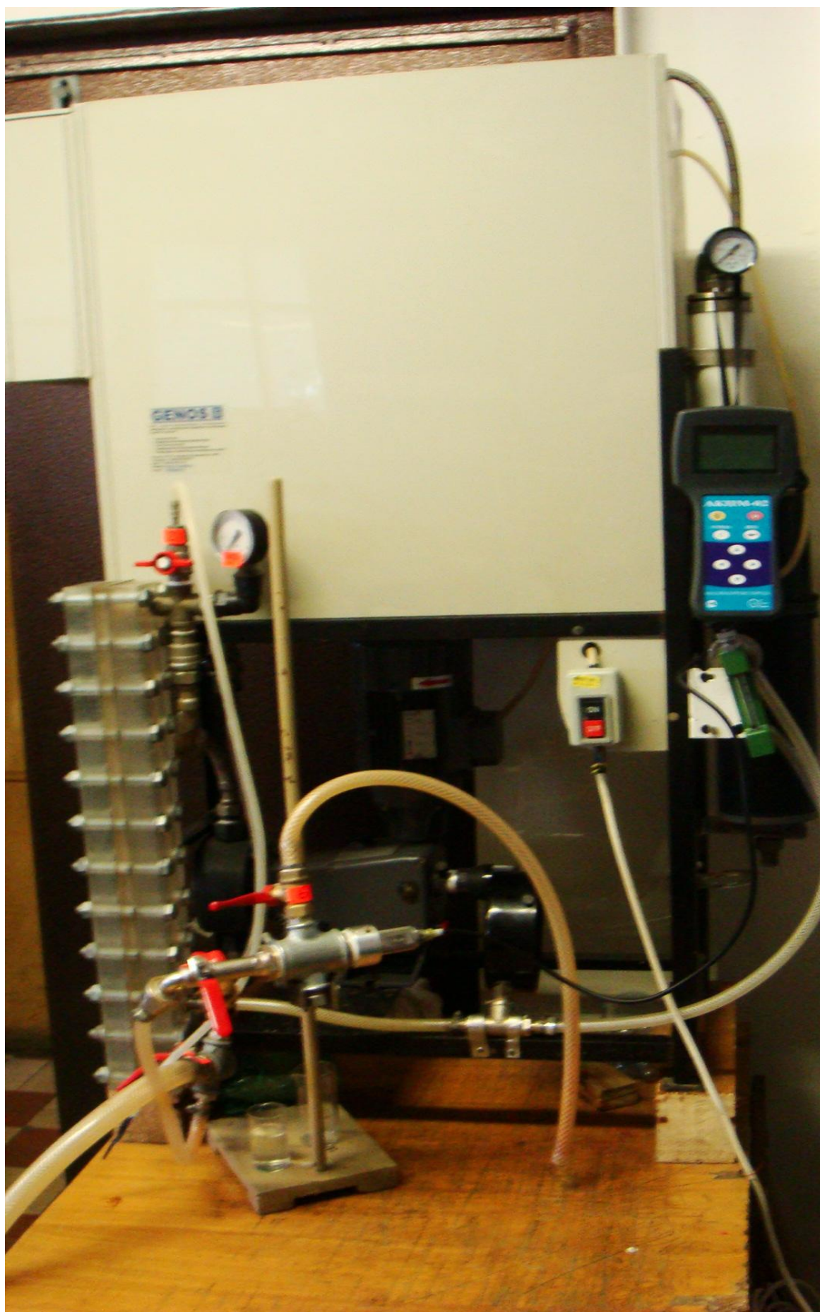
Рисунок 2.4 - Установка по барботированию
