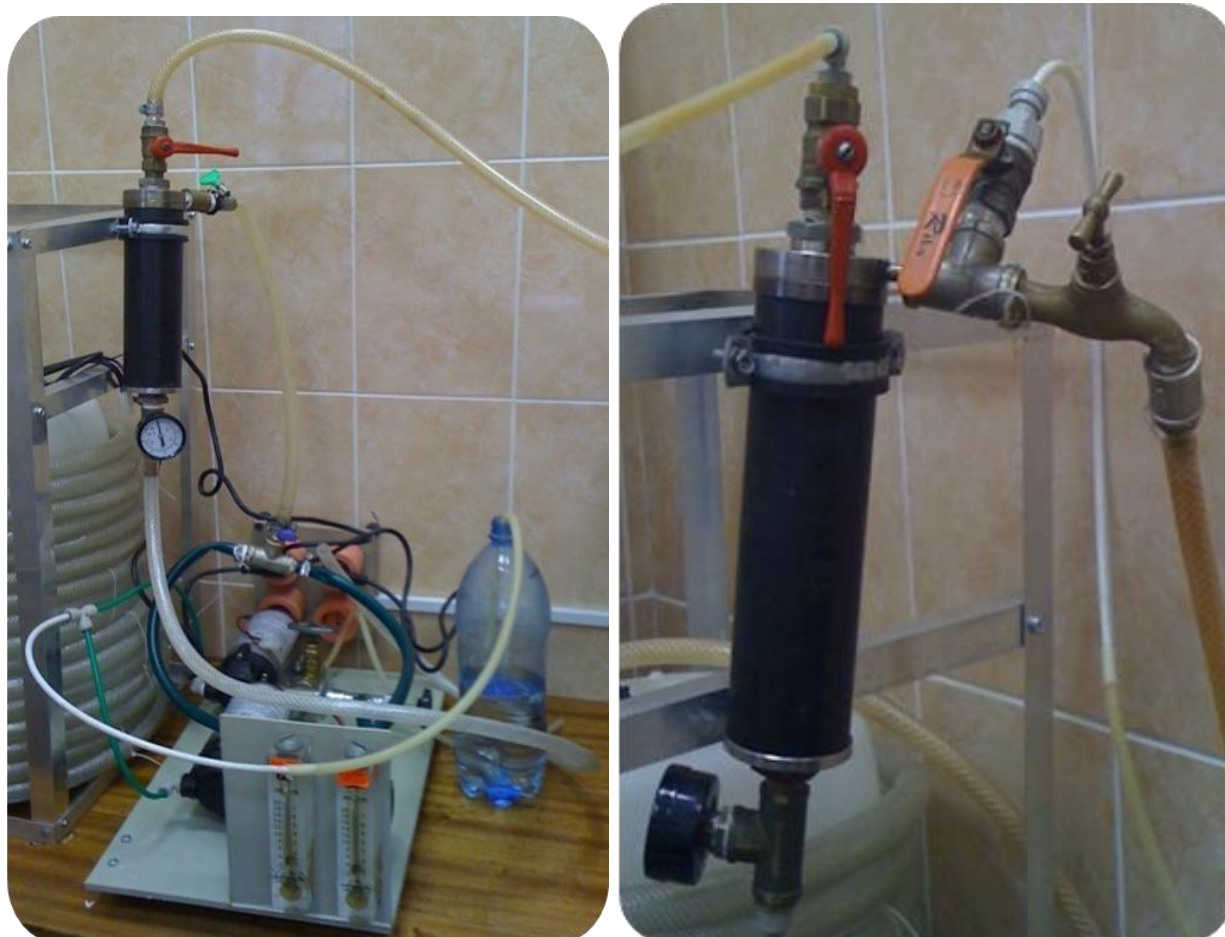
Рисунок 2. 2 - Установка по изучению работы керамических мембран.
