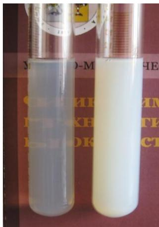
Рис. 3.16. Фотографии эмульсий, стабилизированных смесью Tween 80 и Span 80: наноэмульсия ( $d = 25$  нм), полученная методом инверсии фаз при изменении состава (слева), эмульсия ( $d = 287$  нм), полученная высокоэнергетическим диспергированием (справа). Доля дисперсной фазы – 25 об.%
