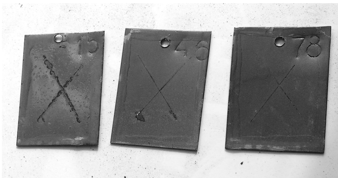
Рисунок 9 – Фотографии образцов после испытания на солестойкость методом погружения.
