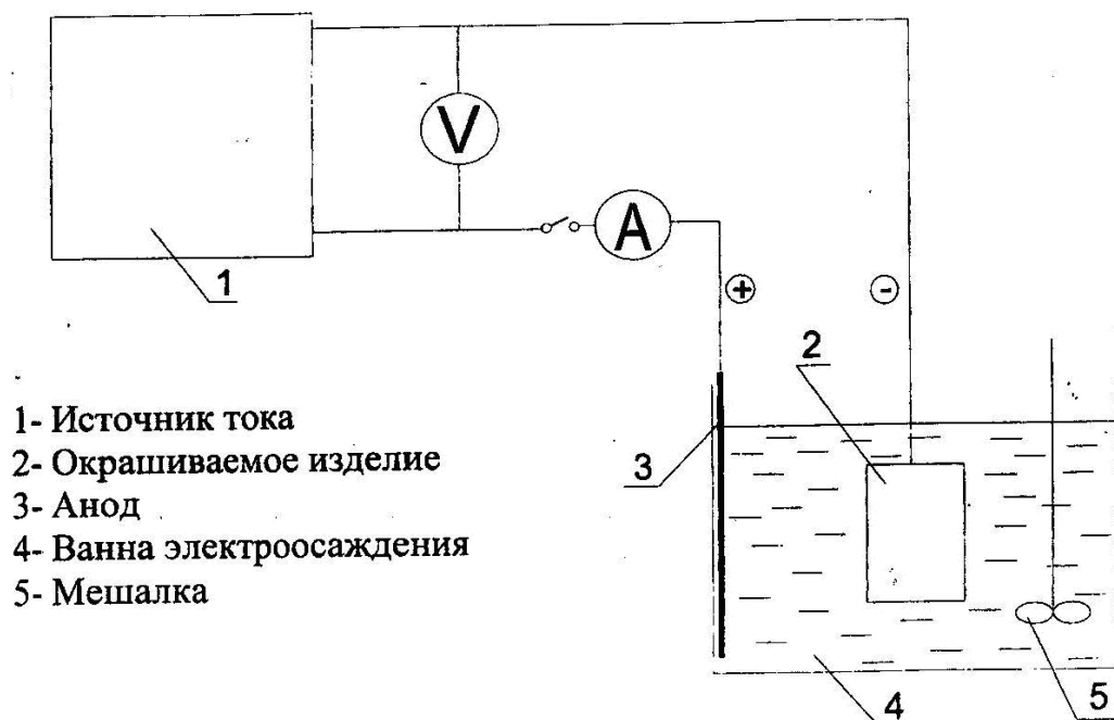
Рисунок 1 – Принципиальная схема установки электроосаждения
