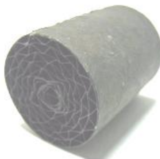
Рис.1.4. Внешний вид сотового катализатора Pt на металлической сетке
