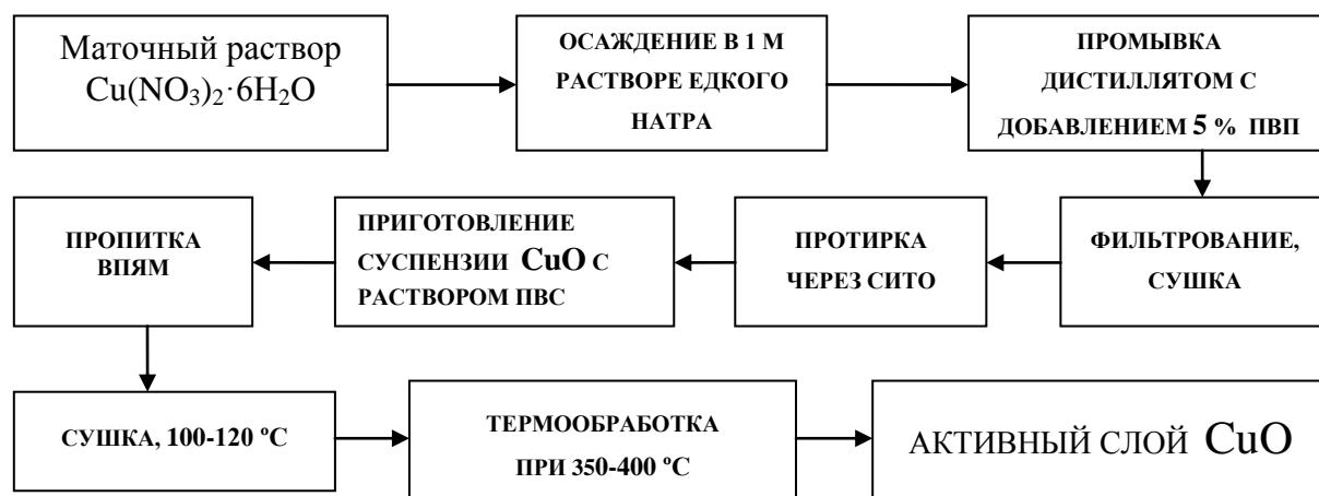
Рис. 2.27. Схема получения активного слоя окислителя водорода CuO/ВПЯМ
