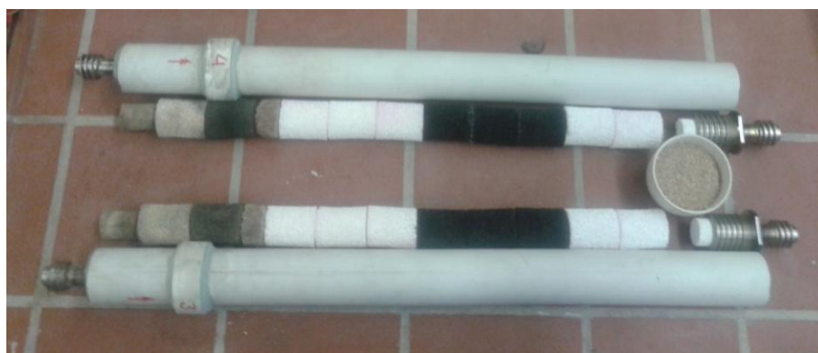
Рис.6.8. Корпуса фильтрэлементов и заполняющие их блочные ВПЯМ
