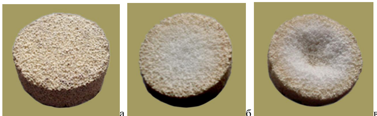
Рис.5.8. Образец цезиевого сорбента ( \gamma -Al 2 O 3 + SiO 2 )/ВПЯМ: а - до испытаний, б - после улавливания паров цезия, в - после снятия соскоба для рентгенофазового анализа
