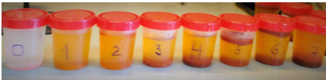
Рисунок 3.8 – Пробы модельного раствора \text{FeSO}_4 , взятые после очередного цикла обработки искровым разрядом.
