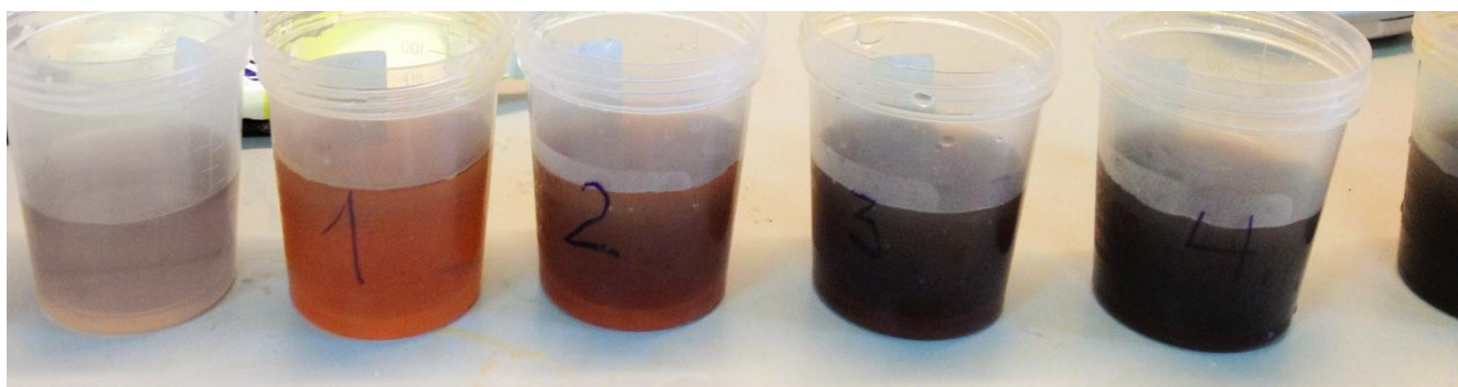
Рисунок 3.14 – Пробы модельного раствора \text{MnSO}_4 , взятые после очередного цикла обработки искровым разрядом.
