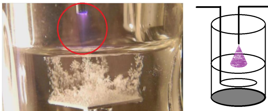
Рисунок 1.5 – Фотография и схематическое изображение возникновения тлеющего разряда по поверхности жидкости.
