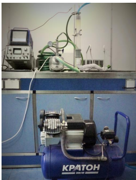
Рисунок 2.4 – Установка электроразрядной обработки воды.
