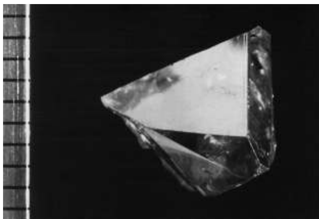
Рис. 1.14. Кристаллы ZnSe, выращенные CVT – методом с транспортным реагентом I_2 (шкала в мм) [55].
