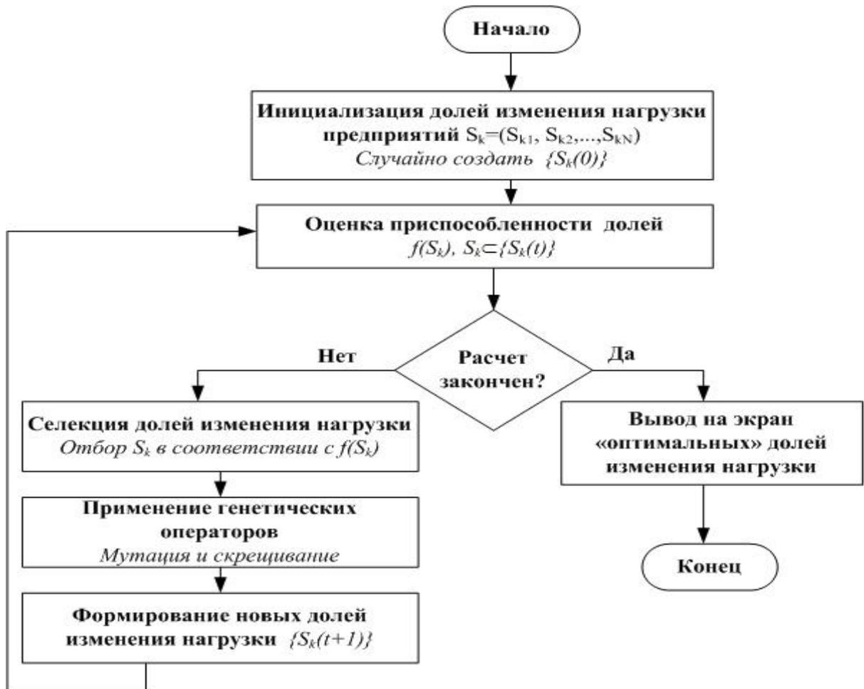
Рисунок 11 - Блок-схема работы генетического алгоритма
