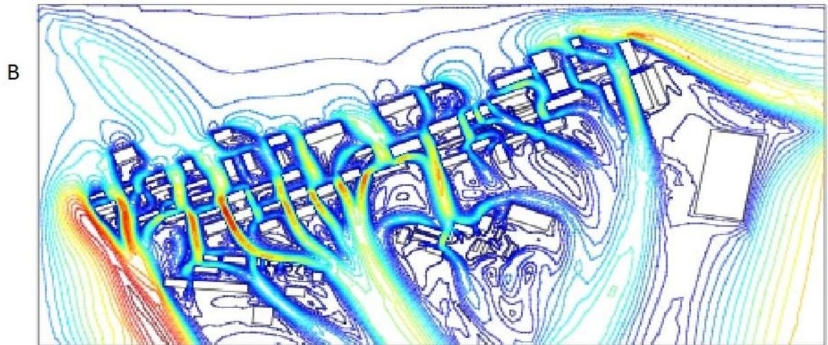
Рисунок 29 - Распространение ЗВ в северной части города при северо-западном направлении ветра: А - в виде 3D поверхности, В - в виде изолиний
