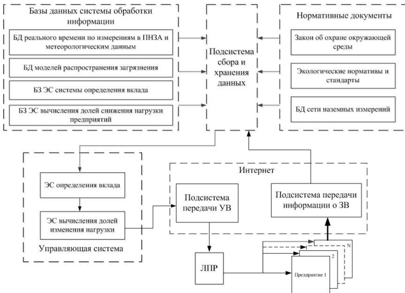
Рисунок 5 - Функциональная структура интеллектуальной системы снижения валового выброса загрязняющих веществ в атмосферу:
