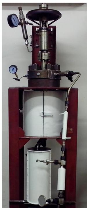
Рисунок 3.4 – Внешний вид установки для получения укрупненных партий угольного пека
