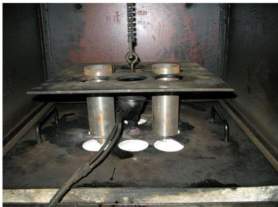
Рисунок 5.5 - Металлические гильзы с коксопековой композицией в
