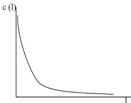
Рисунок 10 - Характер изменения концентрации дисперсной фазы по толщине слоя насадки.
