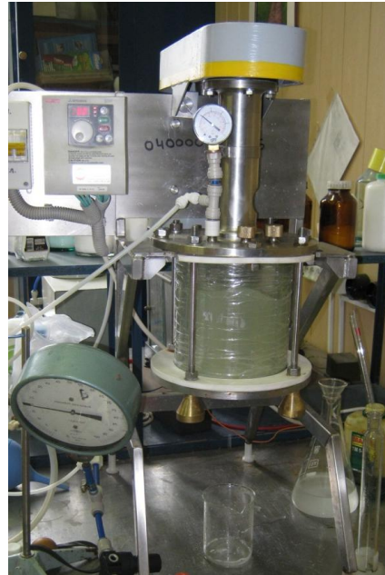
Рисунок 36 – Фотография мембранной установки с подвижным механическим турбулизатором.
