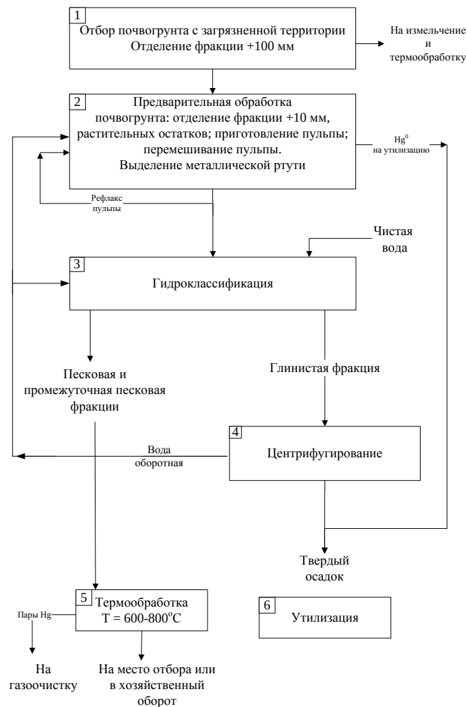
Рисунок 3.33 – Вариант принципиальной технологической схемы очистки ртутьсодержащих почвогрунтов до норм ПДК ртути в почвах
