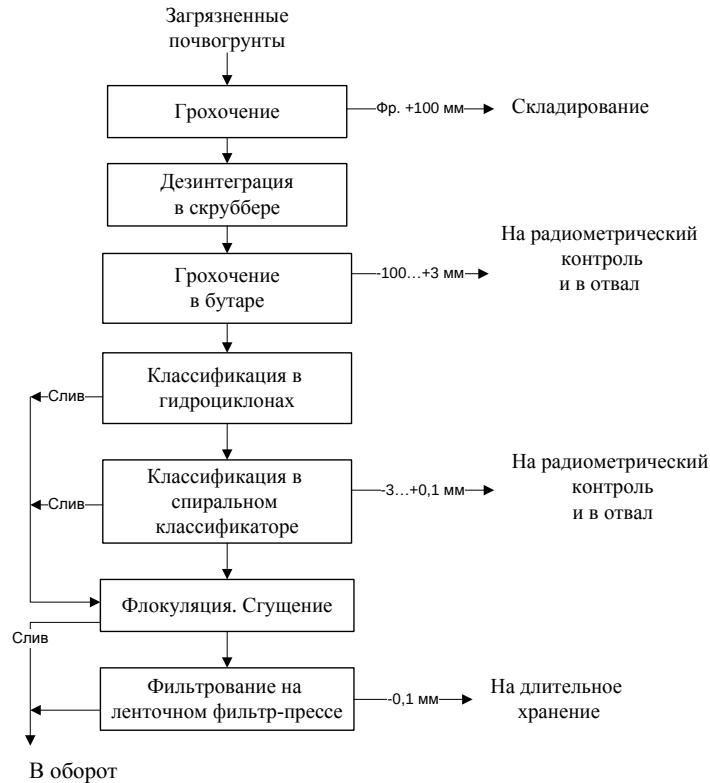
Рисунок 1.3 – Принципиальная технологическая схема очистки радиоактивных почвогрунтов методом гидроклассификации [108]
