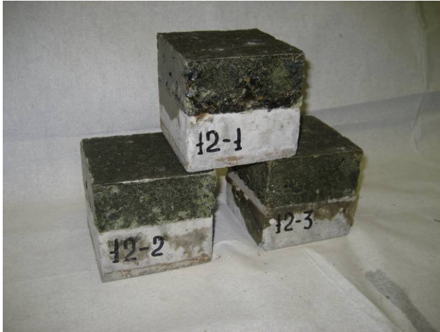
Рисунок 2.2 – Комбинированные образцы для оценки адгезионных свойств высоконаполненных ПКМ на основе акрилового связующего
