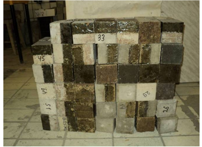
Рисунок 2.2 – Комбинированные образцы для оценки адгезионных свойств высоконаполненных ПКМ на основе акрилового связующего
