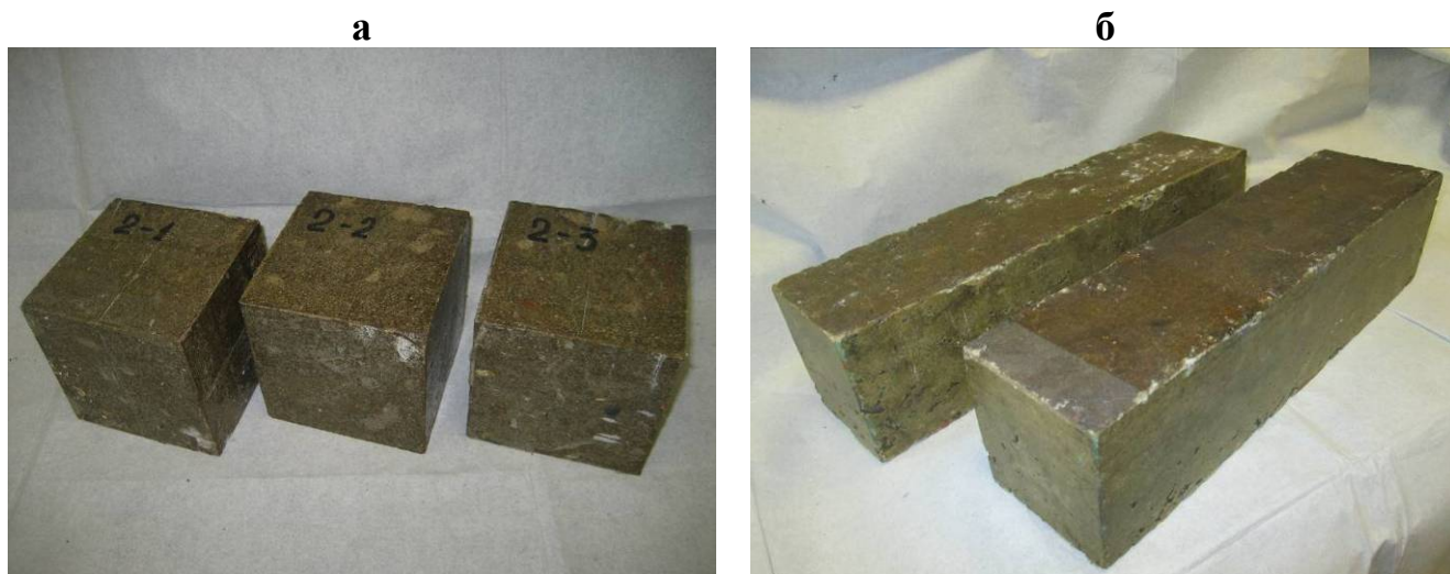
Рисунок 2.1 – Экспериментальные образцы высоконаполненных ПКМ для испытаний на прочность на сжатие (а) и на растяжение при изгибе (б)
