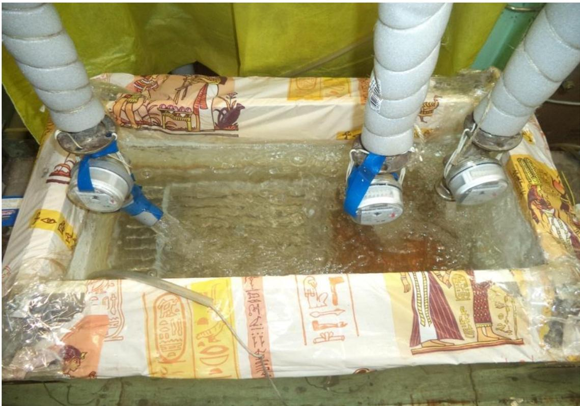
Рис. 2.8. Образование столба жидкости на оросительном устройстве
