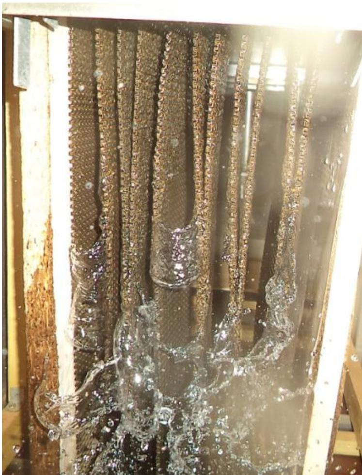
Рис. 4.3. Снос жидкости с насадки при фиктивной скорости газа  $w = 3$  м/с
