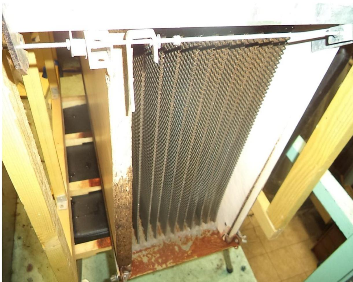
Рис. 2.6. Блок ГПН-насадки в сборе
