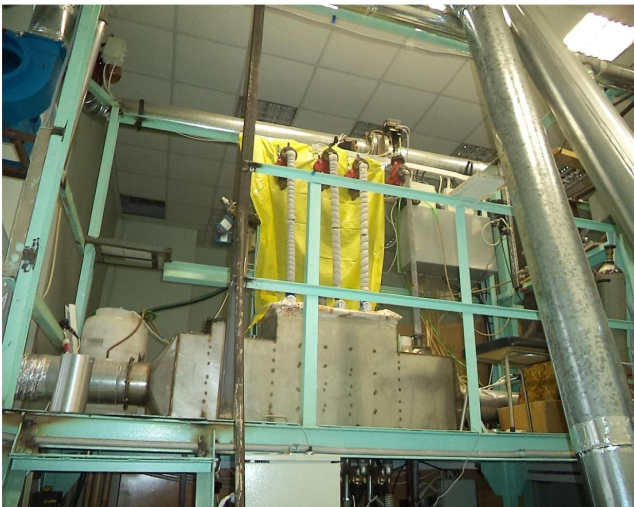
Рис. 2.5. Фотография экспериментальной установки №2 для исследования тепло- и массообмена на гофрировано-просечной насадке
