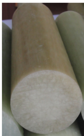
Рисунок 2.1 – Рассматриваемые в работе композитные стержни, изготавливаемые пултрузией
