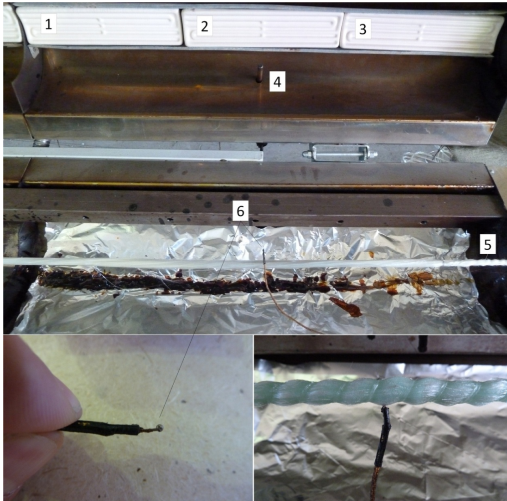
Рисунок 4.3 – Эксперимент по определению температуры внутри стержня 1, 2, 3 – ИК излучатели, 4 – термодатчик первой секции печи, 5 – пропитанный связующим стеклоровинг, 6 – Термопара.
