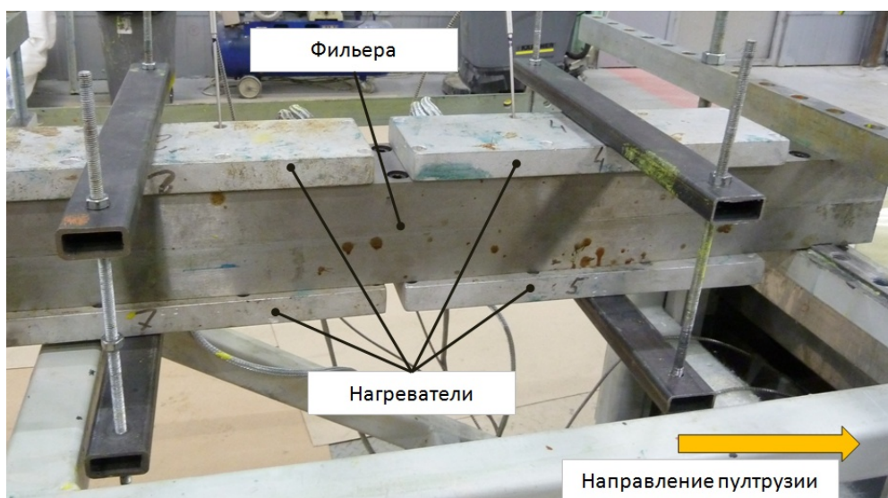
Рисунок 5.1 – Расположение нагревателей на фильере
