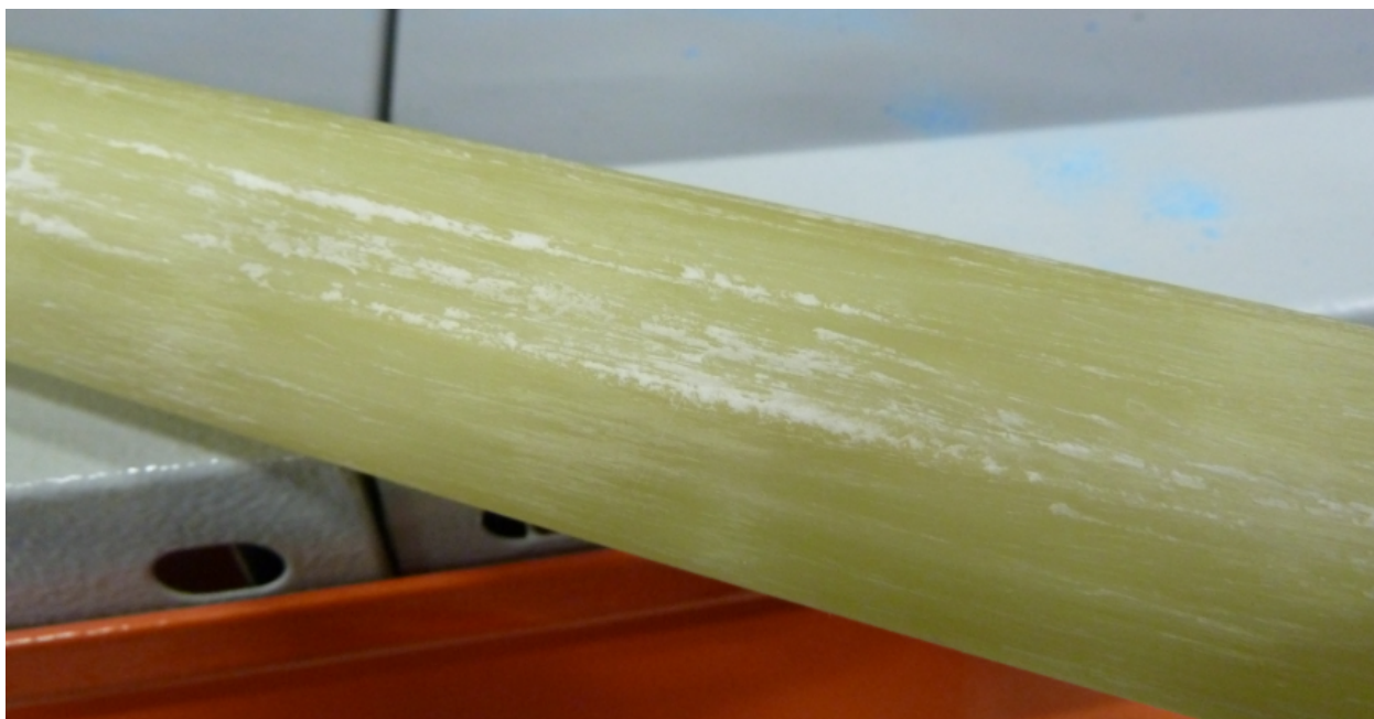
Рисунок 4.22 – Дефект поверхности (шерховатость) пултрузионных стеклопластиковых стержней и труб, полученных на основе смолы Epotec 680
