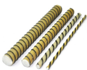
Рисунок 2.4 – Рассматриваемые в работе композитные стержни, изготавливаемые безфильерным способом
