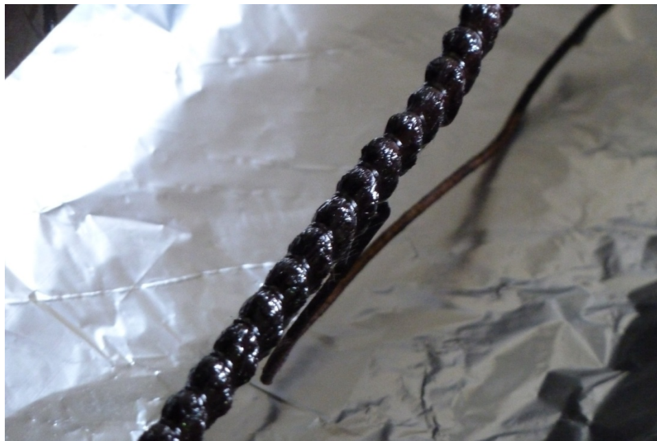
Рисунок 4.9 – Обугленный образец после проведения эксперимента
