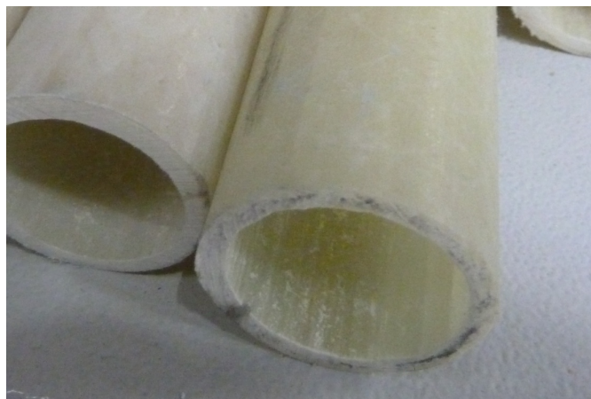
Рисунок 4.31 – Образование некачественных внутренних и внешних поверхностей стеклопластиковой трубы
