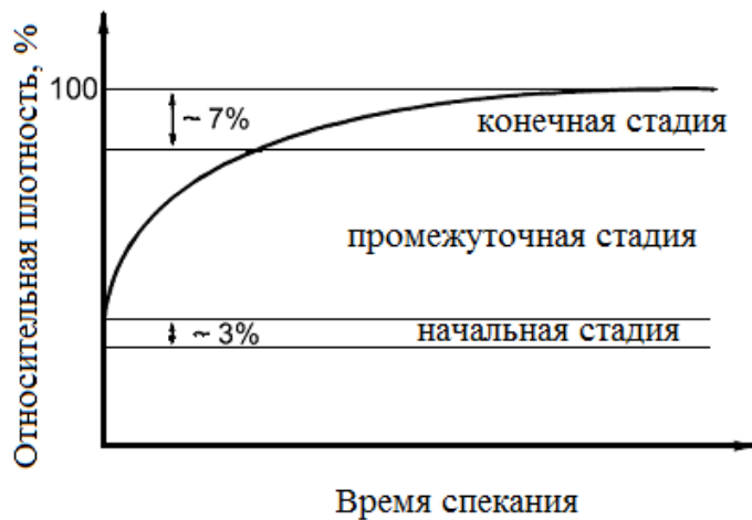
Рисунок 1.8. Изменение относительной плотности прессовки во время спекания.
