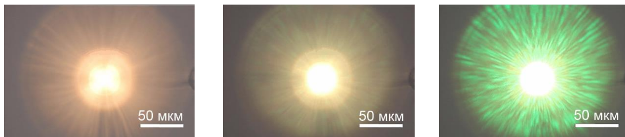
Рисунок 51 - Эффект ГВГ, обусловленный формированием в стекле кристалла \text{LaBGeO}_5 . Вид облучаемой области стекла: а - до формирования кристалла, б - в момент зарождения кристалла, в - при продолжительном воздействии лазерного пучка после зарождения кристалла
