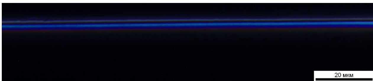
Рисунок 85 - Микрофотография монокристаллического канала, сформированного в объеме лантаноборогерманатного стекла пучком лазера с эллиптическим сечением перетяжки
