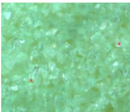
Рис. 2.2. Фрагмент изображения, с выделенными загрязнениями на оптике.
