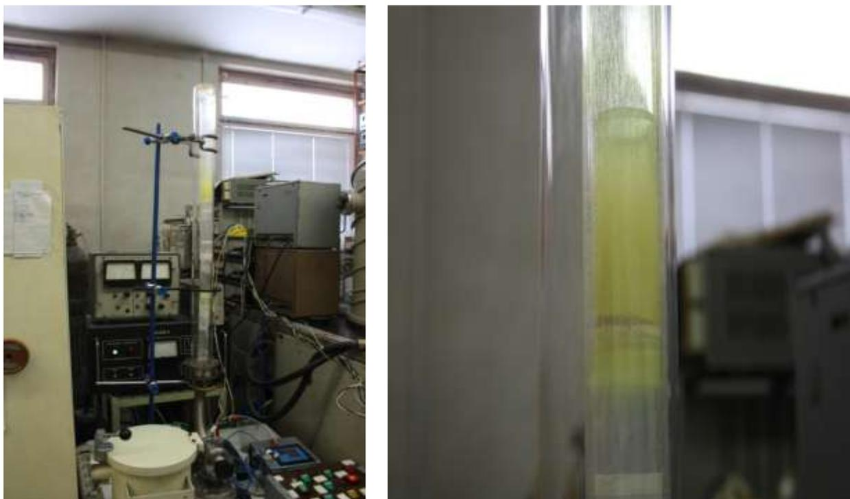
Рис. 4.9. Общий вид сублимационной установки (а) и внутренняя трубка сублиматора (б) при очистке 1,10-фенантролин-три-(бензоилфенилацетоната) европия (БФАЕ).
