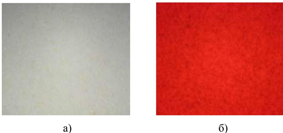
Рис. 4.32. Микрофотографии (x30) 1,10-фенантролин-три-(8-оксихинолята) европия в отраженном свете (а) и УФ-облучении с длиной волны 365 нм (б).
