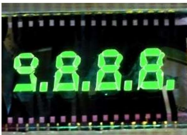
Рис.3.54. Цифровая индикаторная ОСИД-панель, изготовленная из синтезированного  $Alq_3$  (яркость до пробоя  $28000 \text{ кд/м}^2$ ).
