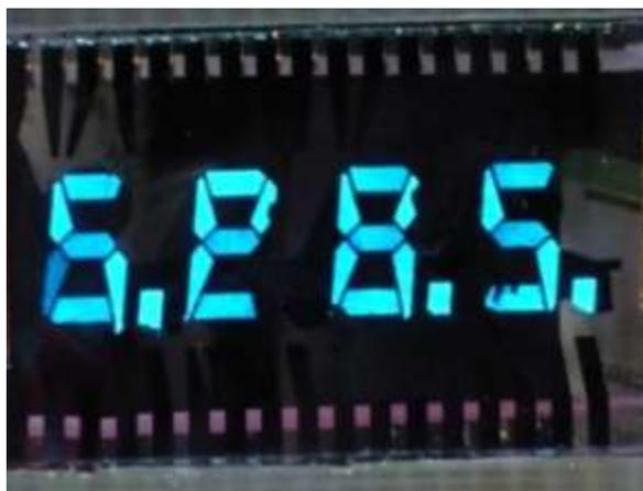
Рис. 3.13. Электролюминесценция тестовой ОСИД-структуры на основе 8-оксихинолята лития.
