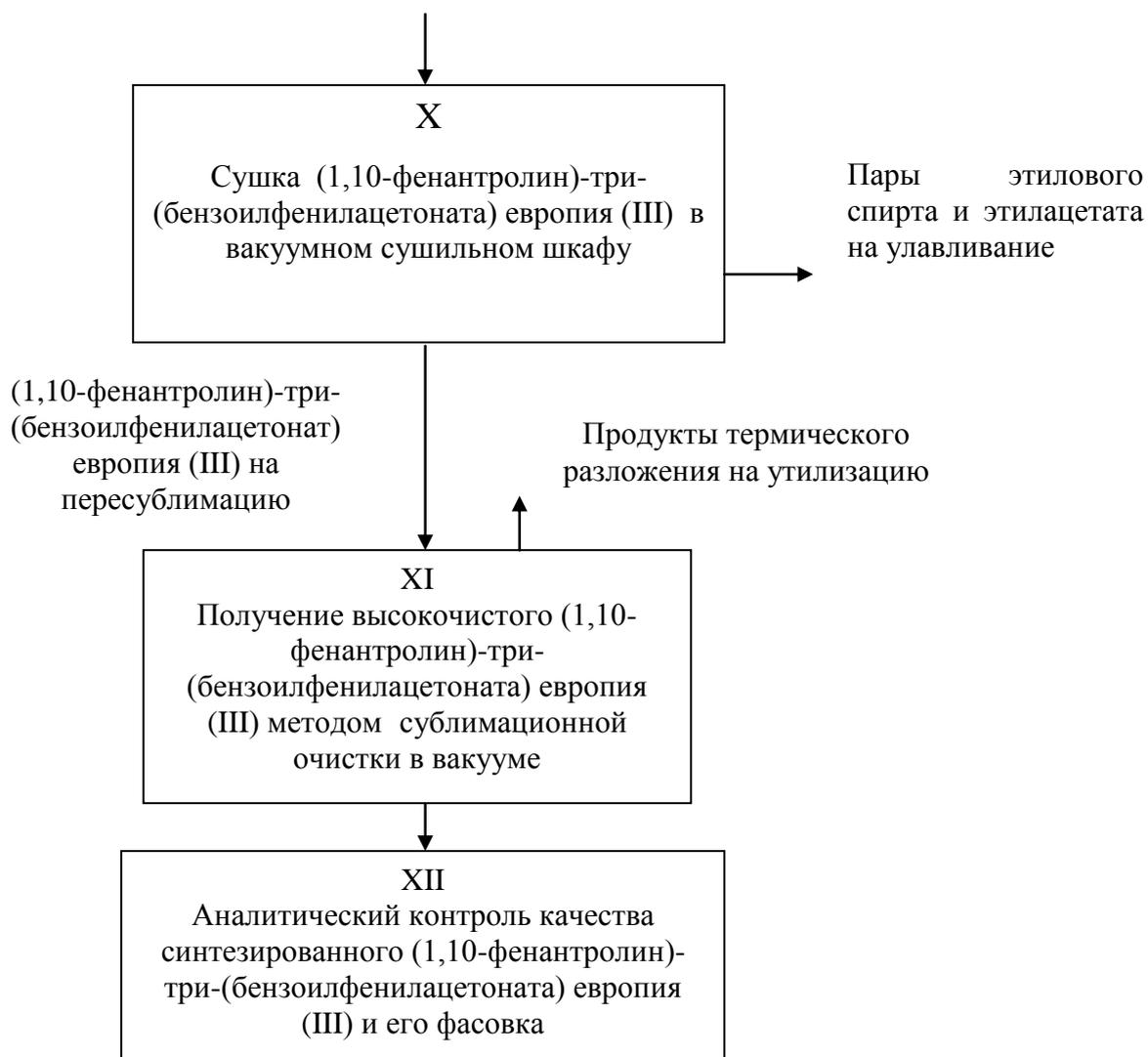
Рис. 4.10. Блок-схема технологического процесса синтеза 1,10-фенантролин-три-(бензоилфенилацетоната) европия (БФАЕ).
