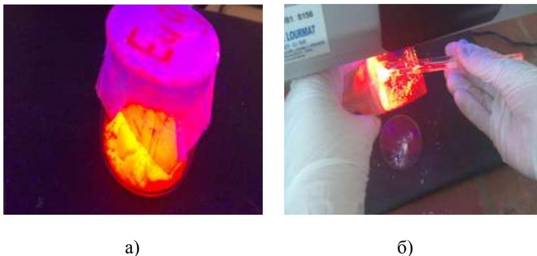
Рис.4.24. Образцы 1,10-фенантролин-три-(теноилтрифторацетоната) европия (а) и 2,9-диметил-4,7-дифенил-1,10-фенантролин-три-(теноилтрифторацетоната) европия (б) при УФ-облучении (365 нм).
