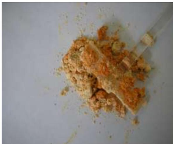
Рис.4.3. Фотографии некондиционного продукта в виде слипшихся комков, полученного при температуре синтеза европиевых комплексов выше 70,0 °С.
