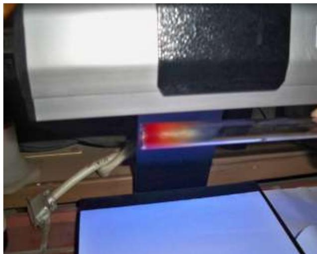
Рис 4.81. Внутренняя трубка сублиматора с очищенным порошком три-(1-фенилизохинолята) иридия (ФИХИ) под УФ-светом (длина волны 365 нм).
