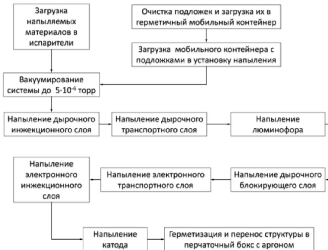
Рис. 3.51. Принципиальная блок-схема технологического процесса формирования тестовых многослойных ОСИД-структур методом вакуумного термического испарения (напыления).
