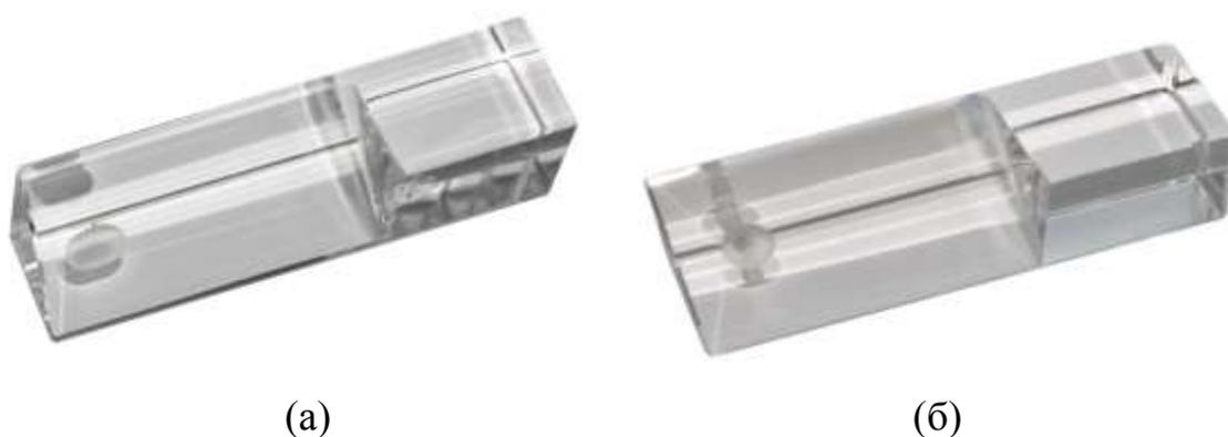
Рис. 2.4. Кювета для измерения спектров фотолюминесценции порошковых люминофоров: конструкция № 1 – (а); конструкция № 2 – (б);
