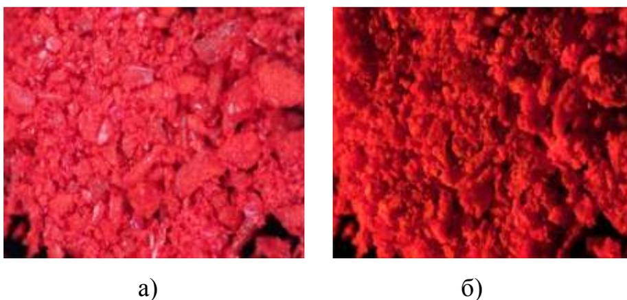
Рис. 5.35. Микрофотографии (x50) N,N,N',N'-тетракис-(4-метилфенил)-4,11-дифенилрубицен-7,14-диамина в отраженном свете (а) и при УФ-облучении с длиной волны 365 нм (б).
