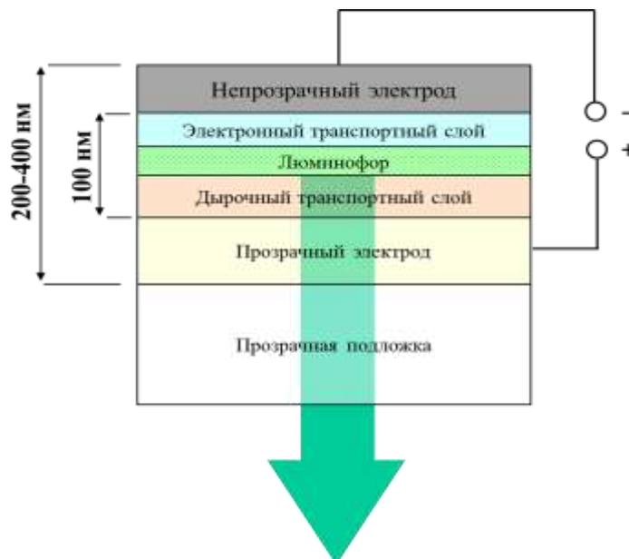
Рис.1.2. Схема и принцип работы типичной ОСИД-структуры.
