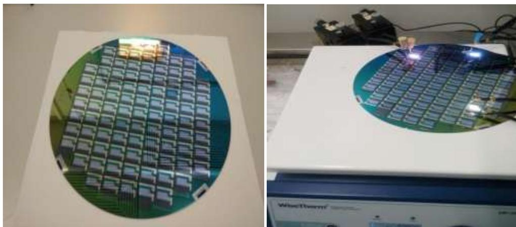
Рис. 5.41. Кремниевая пластина с изготовленными полноцветными микродисплеями МДО 01 ПЦ в момент тестирования.
