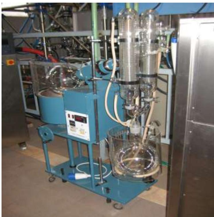
Рис. 3.19. Общий вид лабораторной установки синтеза бис-(2-(2-гидроксифенил)бензотиазолята)- и бис-(2-(2-гидроксифенил)бензоксазолята) цинка.
