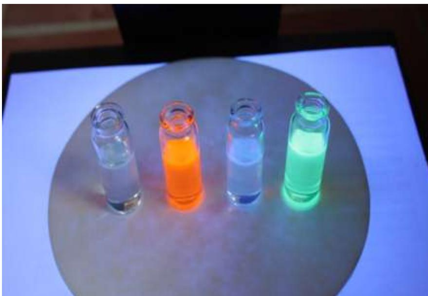
Рис.5.38. Фотолюминесценция растворов материалов, входящих в комплект органических электролюминофоров (слева направо): N,N'-ди-(1-нафтил)-N,N'-дифенилбензидина; N,N,N',N'-тетракис-(4-метилфенил)-4,11-дифенил-рубицен-7,14-диамина; 2-фенил-9,10-ди-(2-нафтил)антрацена; 4-ди-(4-толиламино)-4'-[ди-(4-толиламино)стирил]стильбена при облучении УФ-светом в тетрагидрофуране (ТГФ).
