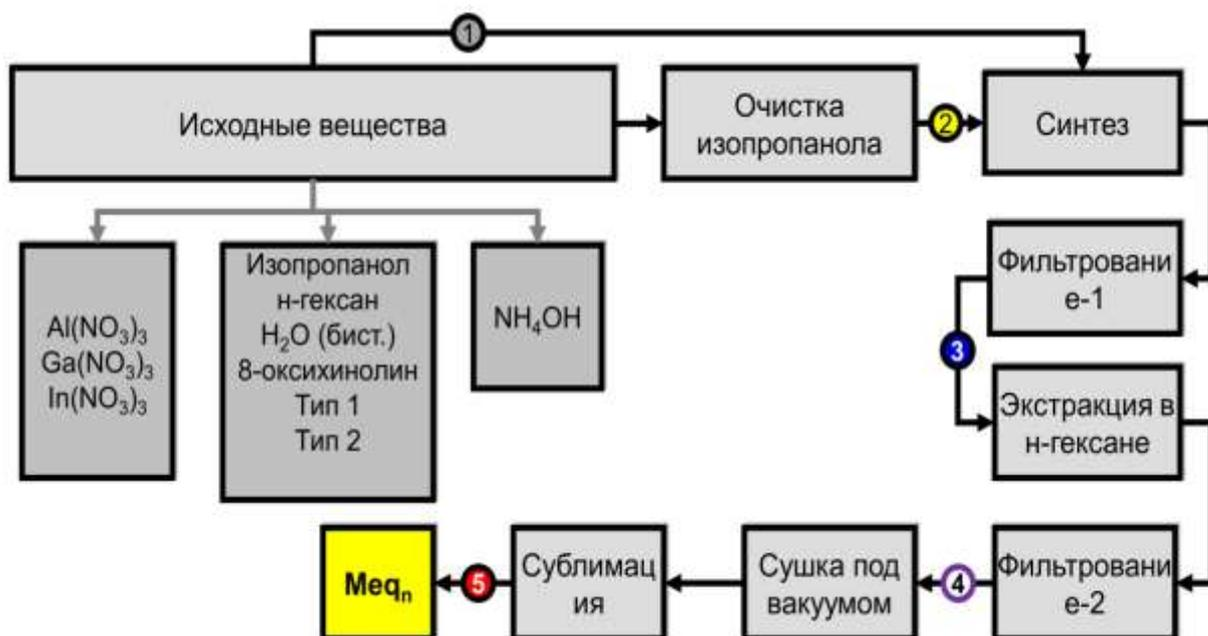
Рис.3.26. Общая блок-схема получения 8-оксихинолятов алюминия, галлия и индия.
