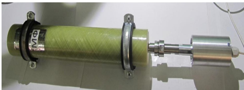
Рис.24.Общий вид компоновки микрофильтрационного элемента и ультразвукового модуля.
