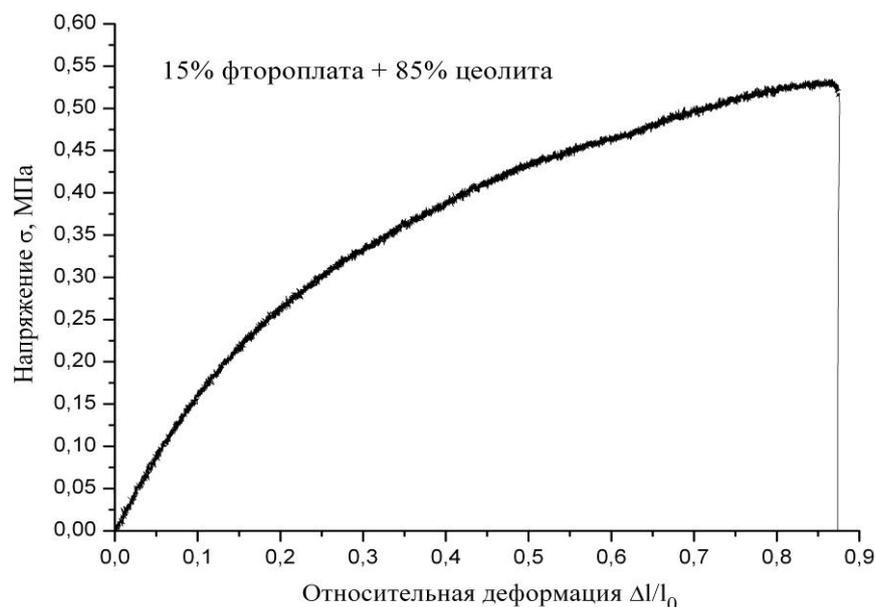
Рис. 3.2. График зависимости силового отклика образца КСАМ от величины его относительной деформации.
