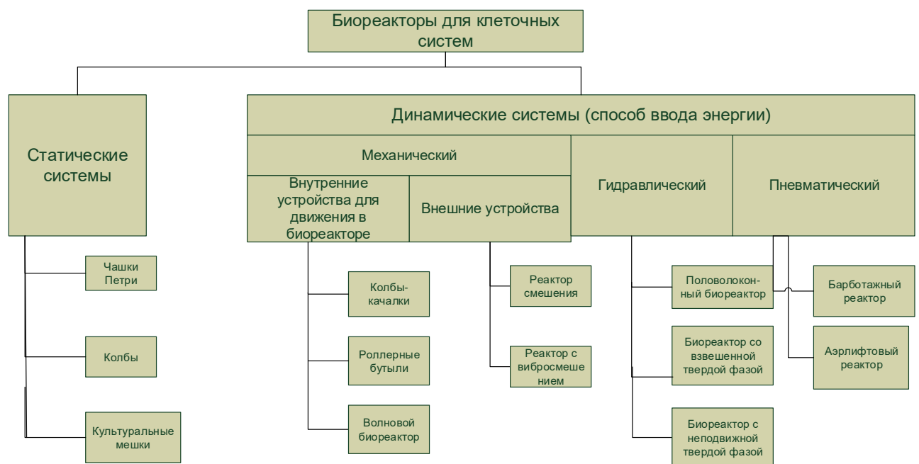
Рисунок 1.1 - Классификация биореакторов для культивирования клеток млекопитающих
