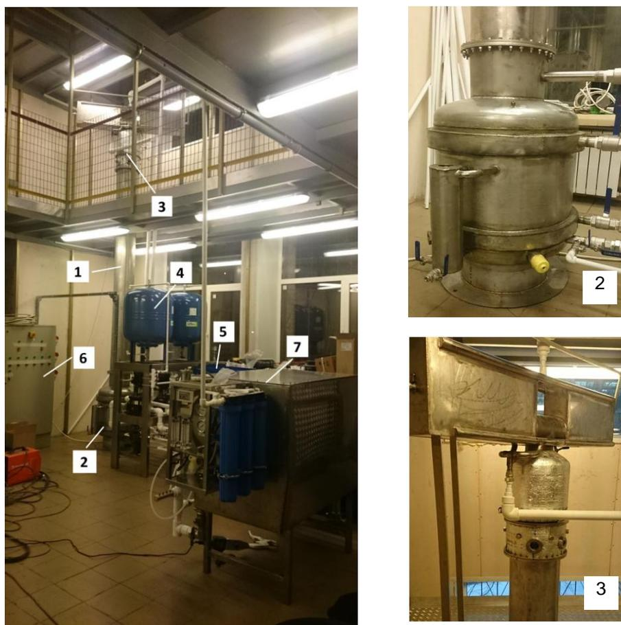
Рис. 2.3. Лабораторный стенд с колонной диаметром 250 мм
