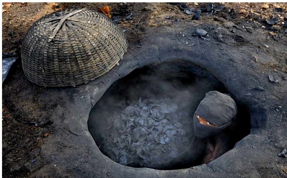
Рис. 3.2. Один из широко практикуемых примитивных способов производства угля из скорлупы кокосовых орехов
