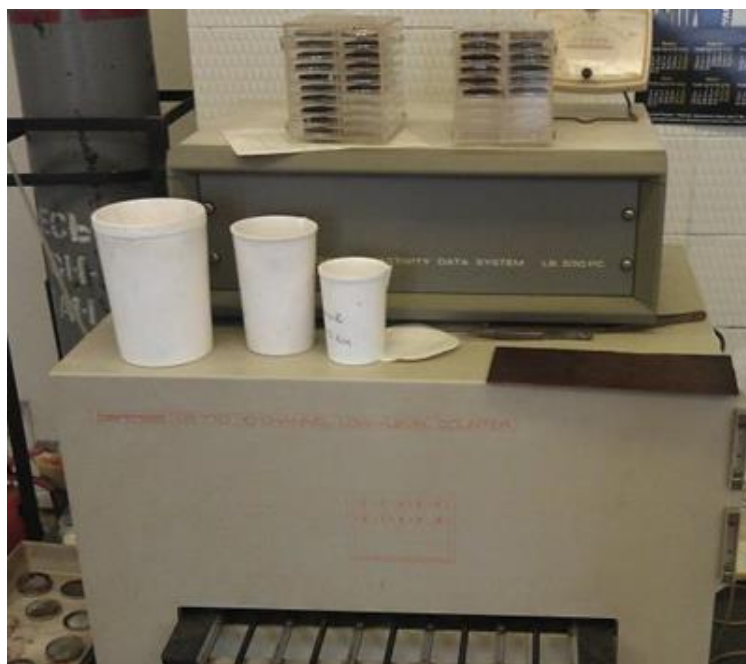
Рисунок 4. Низкофоновый, десятиканальный альфа- бета-радиометр LB-770
