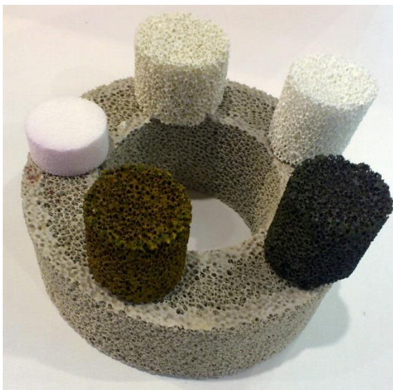
Рисунок 1.11. Керамические ВПЯМ полученные методом дублирования матрицы (кафедра общей химической технологии РХТУ им. Д.И. Менделеева)
