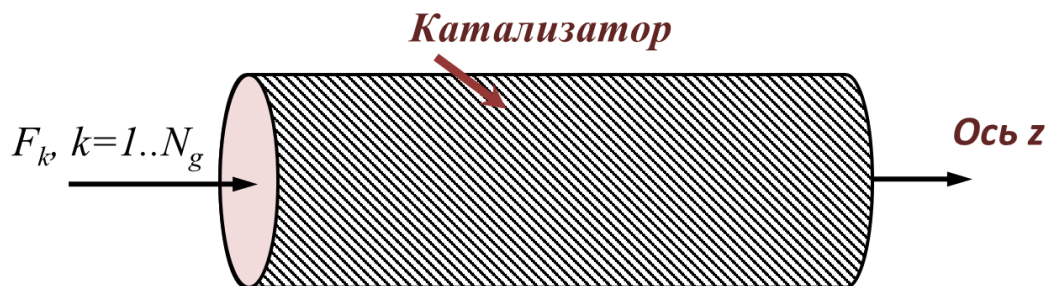
Рисунок 3.4. Геометрическая модель изотермического трубчатого реактора с неподвижным слоем катализатора
