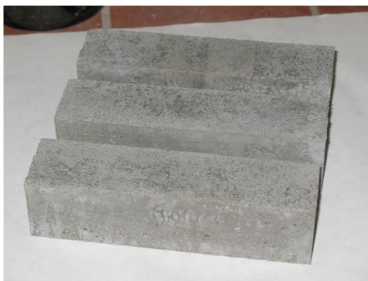
Рисунок 4.32 – Образцы цементного камня после 300 циклов замораживания и оттаивания
