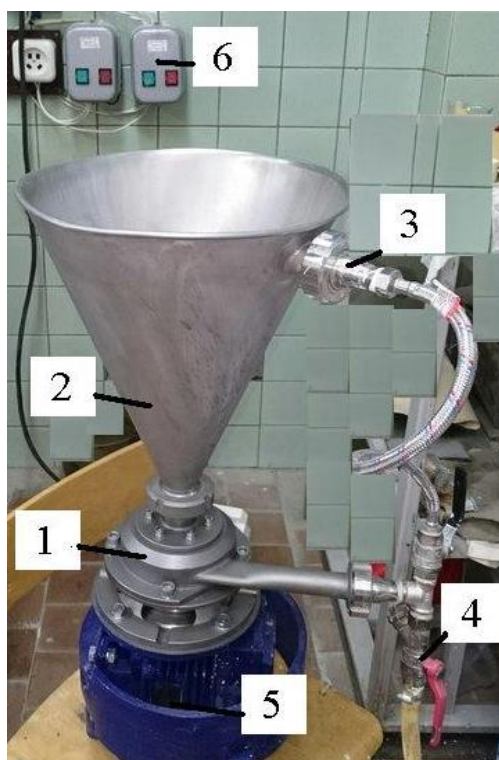
Рисунок 2.5 – Лабораторный роторно-пульсационный аппарат - смеситель (РПА)
