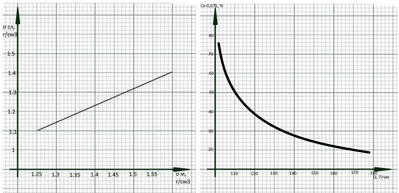
Рисунок 2.21 - Статические характеристики процессов измельчения и классификации: а – гидроциклона по каналу «плотность питания – плотность слива»; б – шаровой мельницы по каналу «производительность – содержание класса -0,071 мм в сливе гидроциклона»
