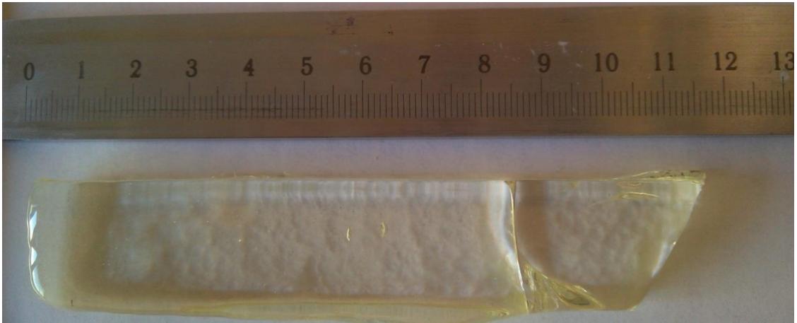
Рисунок 72 – Штабик стекла размером 80x20x15 мм для вытяжки волокна.
