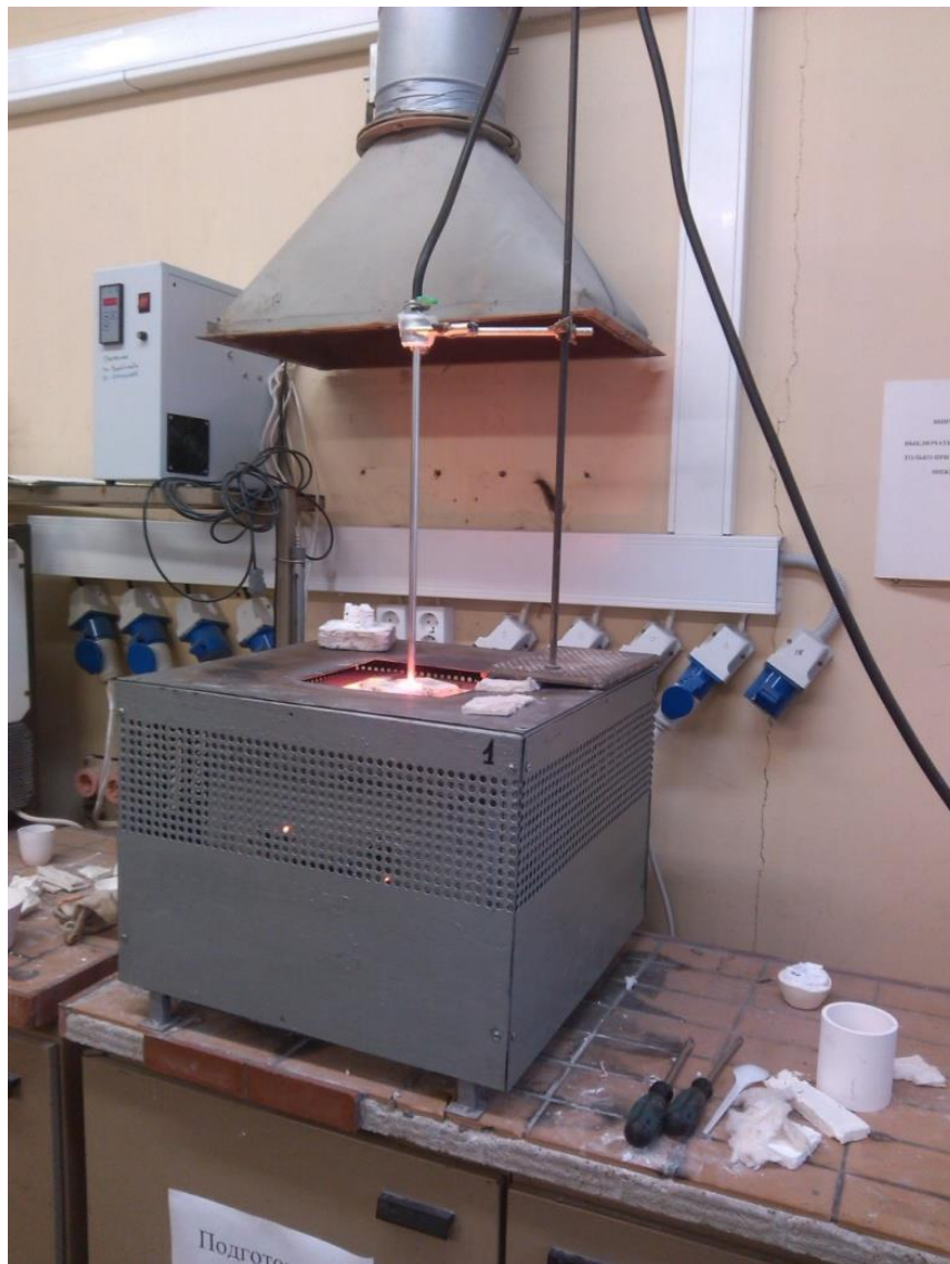
Рисунок 30 – Лабораторная варочная печь с возможностью бурления стекломассы газом.
