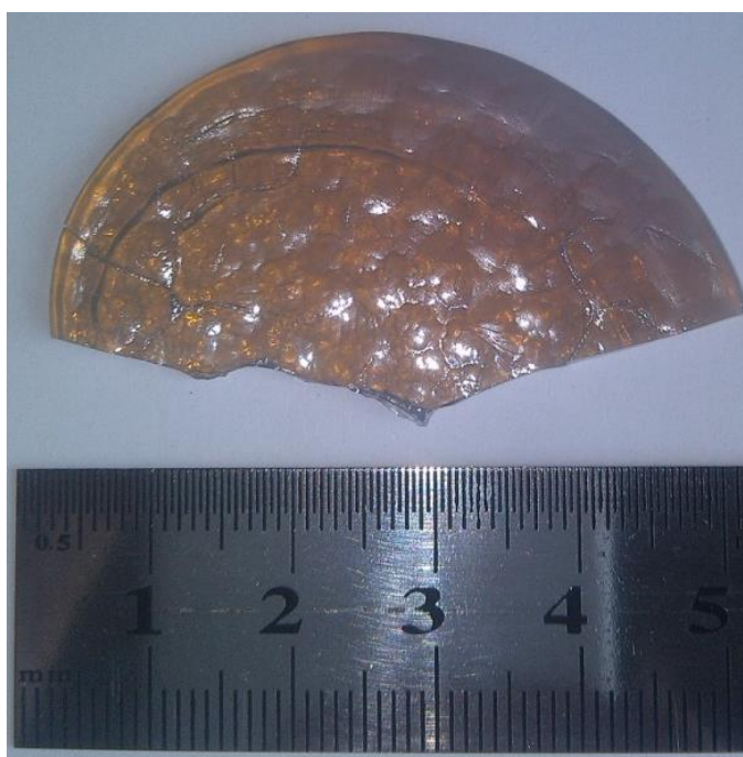
Рисунок 35 – Фотография стекла состава 10Y_2O_3-30Al_2O_3-60V_2O_5 и 30Sb_2O_3 сверх 100%.
