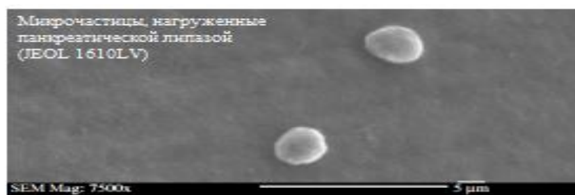
Рисунок 3.15 – Определение размера микрочастиц, нагруженных панкреатической липазой (сканирующий электронный микроскоп JEOL 1610LV с энергодисперсионным спектрометром для электронно-зондового микроанализа SSD X-Max Inca Energy).
