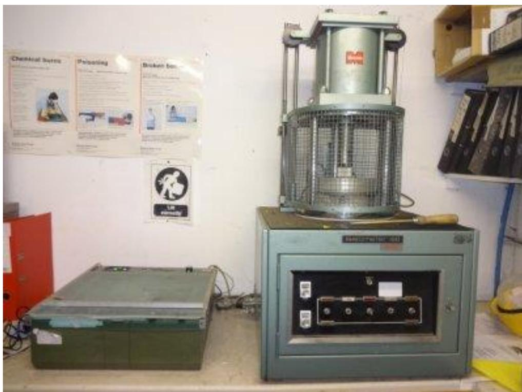
Рисунок 27. Виброреометр роторного типа Монсанто М-100.
