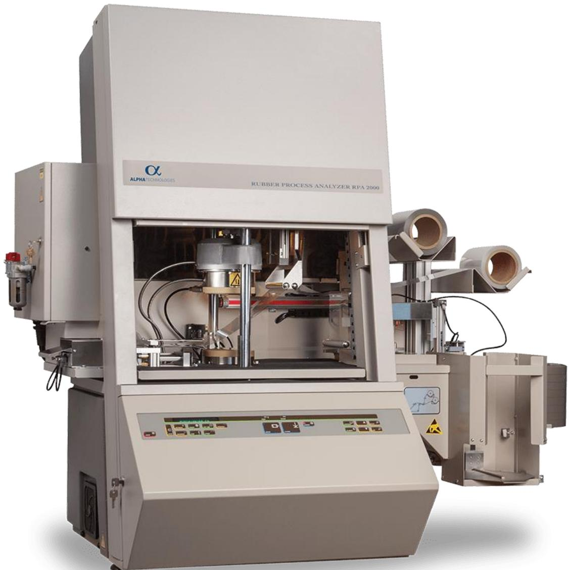
Рисунок 28. Прибор Анализатор перерабатываемости резин RPA-2000
