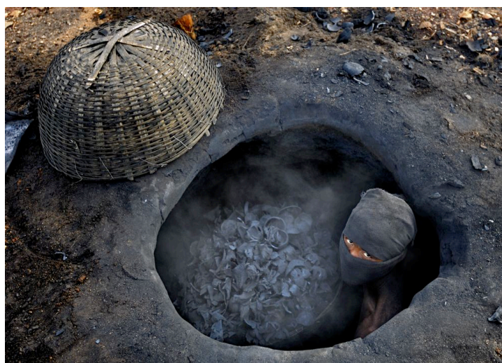
Рис. 3.2. Один из широко практикуемых примитивных способов производства угля из скорлупы кокосовых орехов
