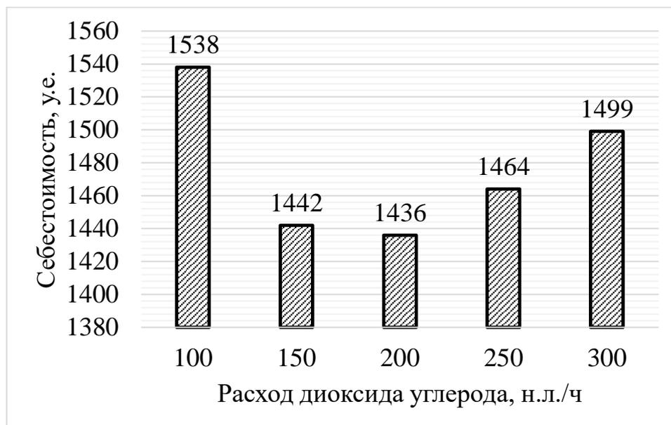
Рисунок 3.29 – Себестоимость аэрогеля в форме части диаметром 2.7 мм получаемых на установке для сверхкритической сушки при различном расходе диоксида углерода
