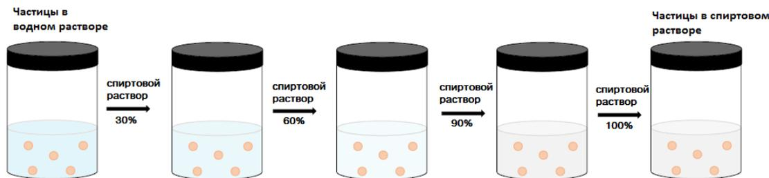
Рисунок 3.1 – Схема многоступенчатой замены растворителя
