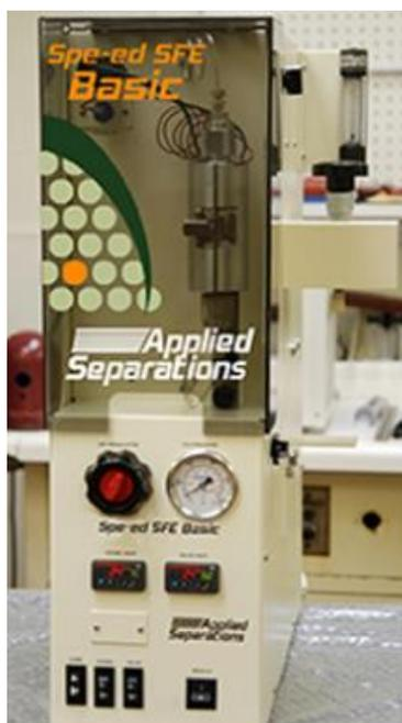
Рисунок 1.13 – Установка для проведения сверхкритической сушки (Speed SFE Basic), университет города Кос, Турция
