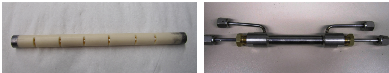
Рис 2.2. Мембрана MFI в перфорированной трубке (слева) и мембранный модуль (справа)
