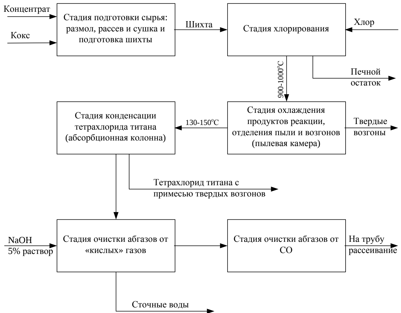
Рисунок 4.30 — Блок-схема опытно-промышленной установки хлорирования кварц-лейкоксового концентрата
