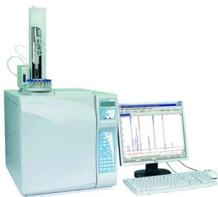
Рис. 2.4.1. Газовый хроматограф “Хроматэк - Кристалл 5000”
