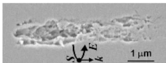
Рисунок 1.2.1.2 – Изображение, полученное с помощью СЭМ во вторичных электронах, структуры, записанной лазерным пучком круговой поляризации [38].
