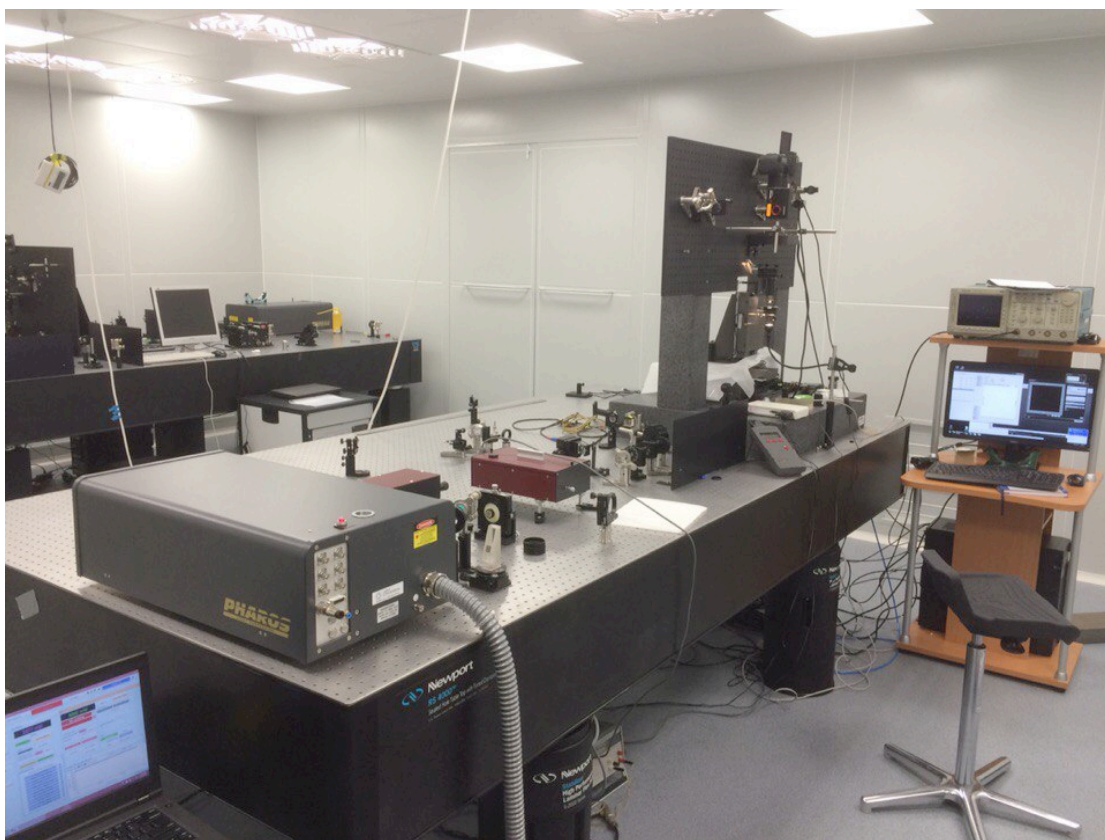
Рисунок 2.2.1.1 – Фотография установки лазерного модифицирования материалов на основе лазера Pharos SP.
