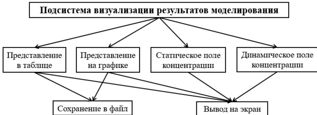
Рис. 3.6. Структура подсистемы визуализации результатов моделирования
