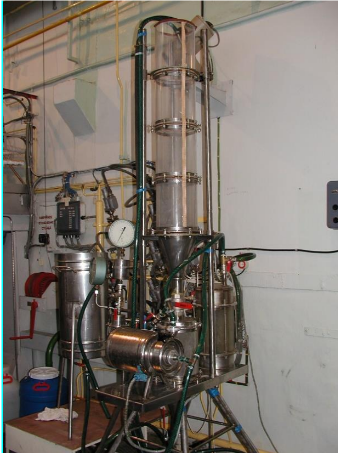
Рисунок 16 – Опытная установка для исследования сорбционно-мембранных процессов очистки модельных ЖРО АЭС
