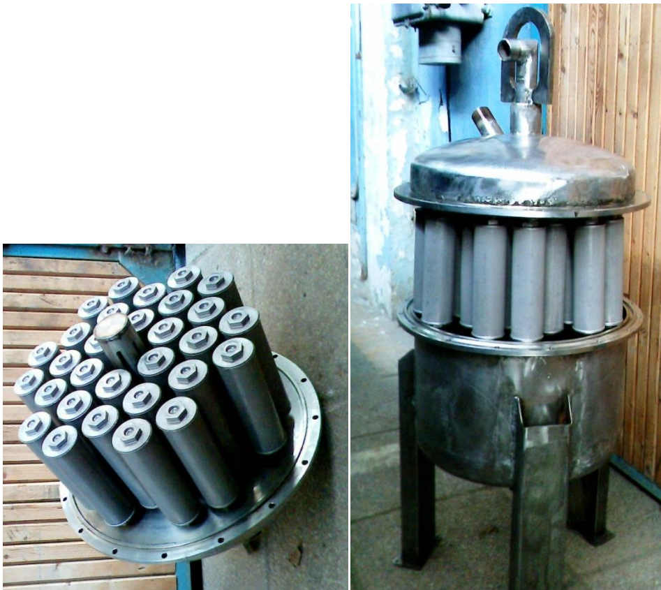
Рисунок 26 – Гексагональная упаковка 30-ти мембранных фильтроэлементов
