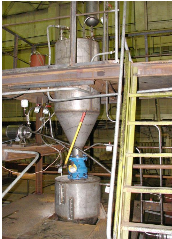
Рисунок 38 – Опытная демонстрационная установка по переработке реальных ЖРО.
