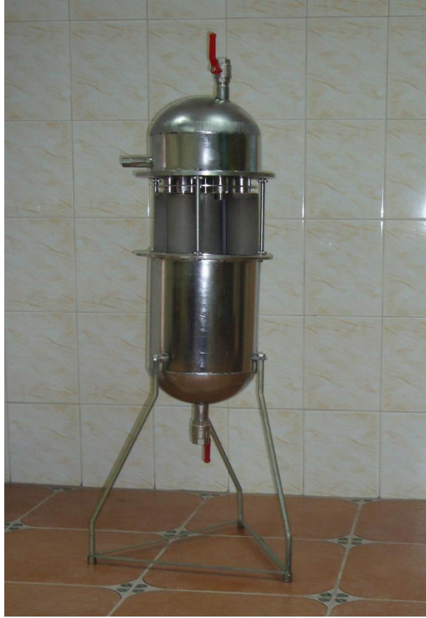
Рисунок 24 – Общий вид фильтра с 7-ю мембранными фильтроэлементами
