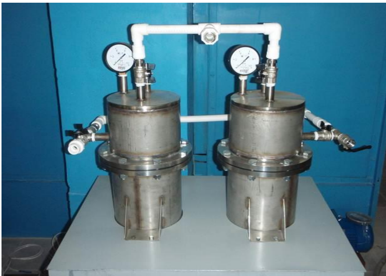
Рисунок 39 – Внешний вид модуля мембранной очистки
